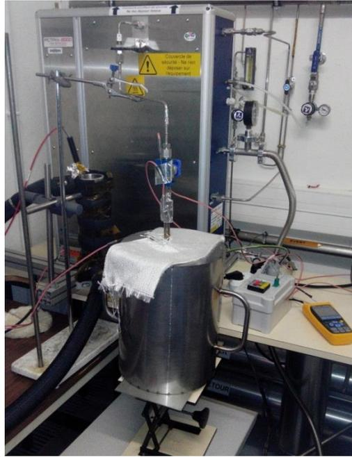
**Figure 2-5 - Banc d'hydrogénation *PCT-pro* équipé d'un four tubulaire.**
