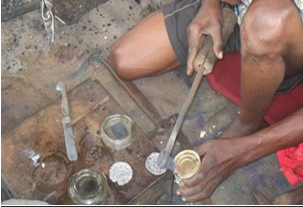
Soudage avec un fer à souder
