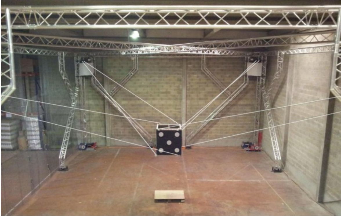
Figure 1.9 – Robot suspendu CoGiRo à 8 câbles et 6 degrés de liberté au LIRMM à Montpellier
