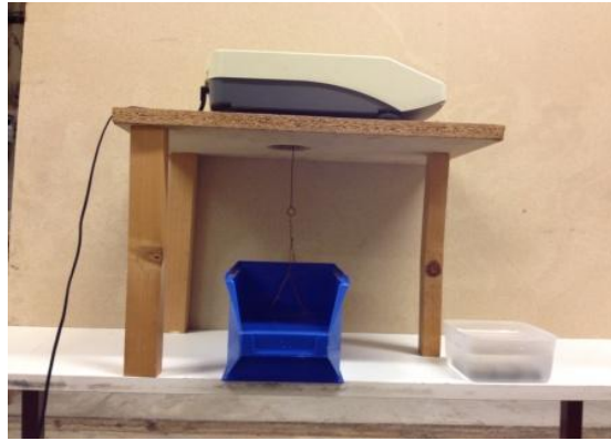
Figure II.5 : dispositif expérimental de pesée hydrostatique.
