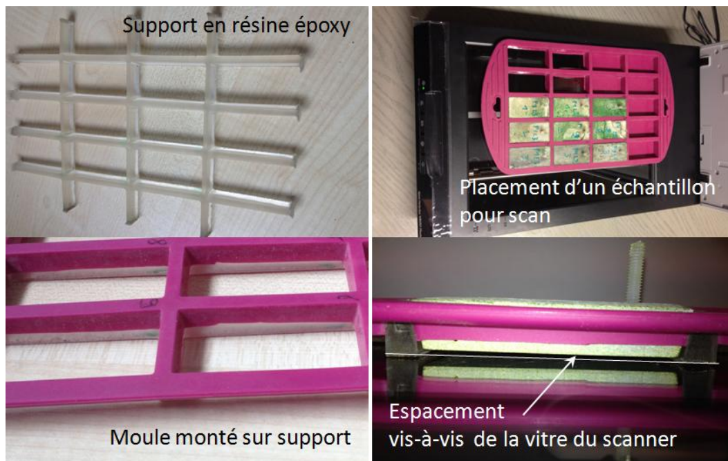
Figure II.27 : dispositif pour la numérisation des échantillons.
