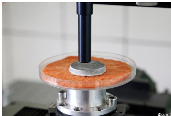
Figure II. 22. Mesure de rugosité au profilomètre confocal sur pastille de pâte de ciment
