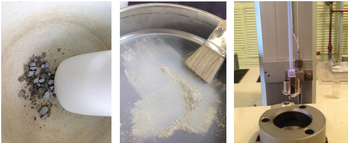
Figure II. 17. a) Broyage des échantillons au pilon et mortier ; b) Tamisage à 0,63 mm ; c) Creuset pâte de ciment et creuset de référence sur thermobalance.
