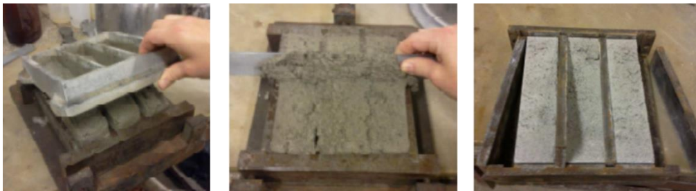
Figure II. 4. a) moule après passage à la table à chocs; b) arasage; c) éprouvettes démoulées à 24H
