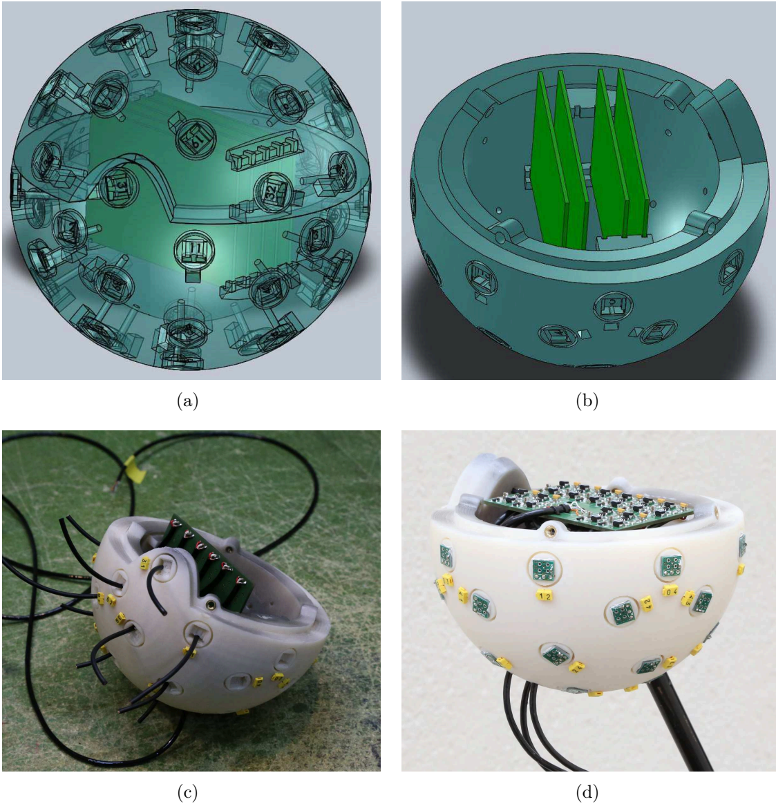
Figure 6.10 Support en plastique de l'antenne MemsBedev réalisé en impression 3D. (a) Vue en transparence sous SolidWorks (b) Vue de la demi-boule inférieure avec 4 circuits électroniques matérialisés par des plaques vertes (c) Demi-boule inférieure partiellement câblée. (d) Demi-boule inférieure câblée et montée sur un pied de microphone.
