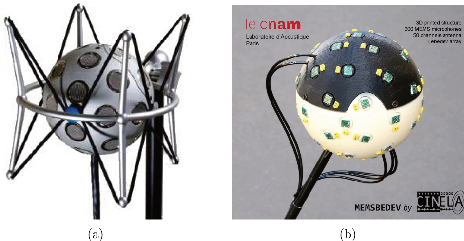
Figure 2.8 Exemples de réseaux de microphones sphériques répartis sur une sphère rigide. (a) Microphone EigenMike 32 TM permettant une estimation des composantes ambisoniques jusqu'à l'ordre M = 4 . (b) Microphone MemsBedeV permettant une estimation des composantes ambisoniques jusqu'à l'ordre M = 5 .
