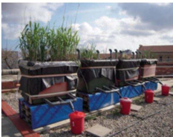
Figure 4-19 : Lits de séchage plantés de roseaux expérimentaux pour le traitement des boues résiduaires (Argilaga, 2011)
