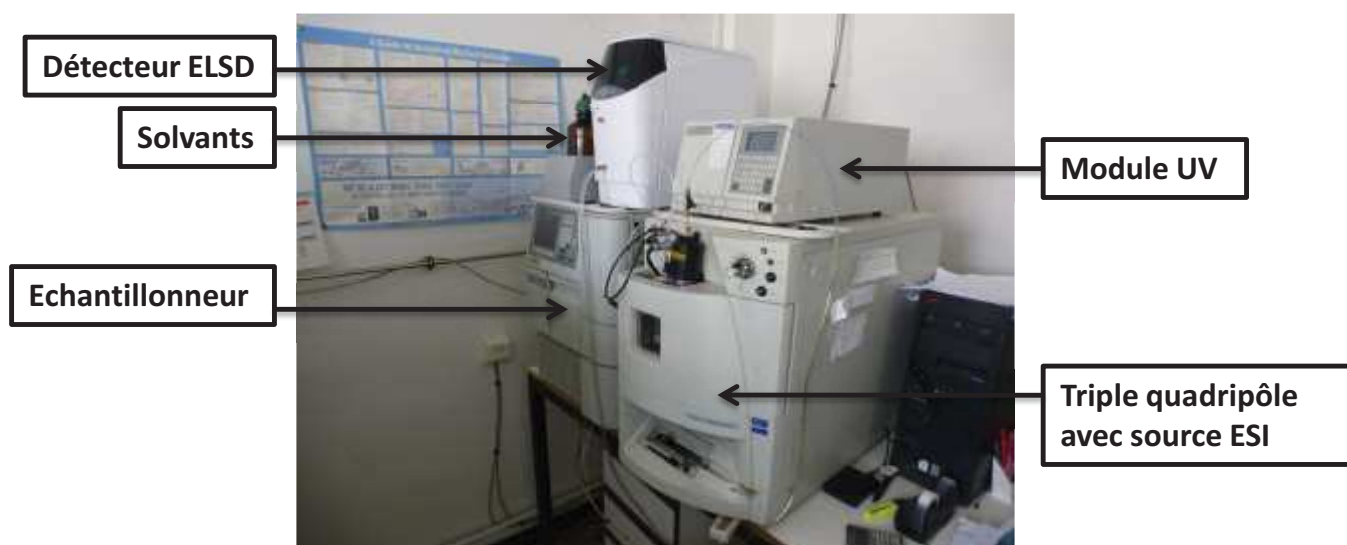
Illustration 4 : Photographie légendée de l'analyseur à triple quadripôle pour l'analyse LC-MS de routine
