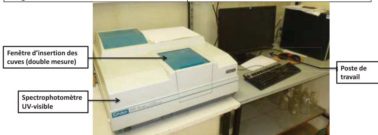
Illustration 18 : Photographie légendée du spectrophotomètre UV-visible
