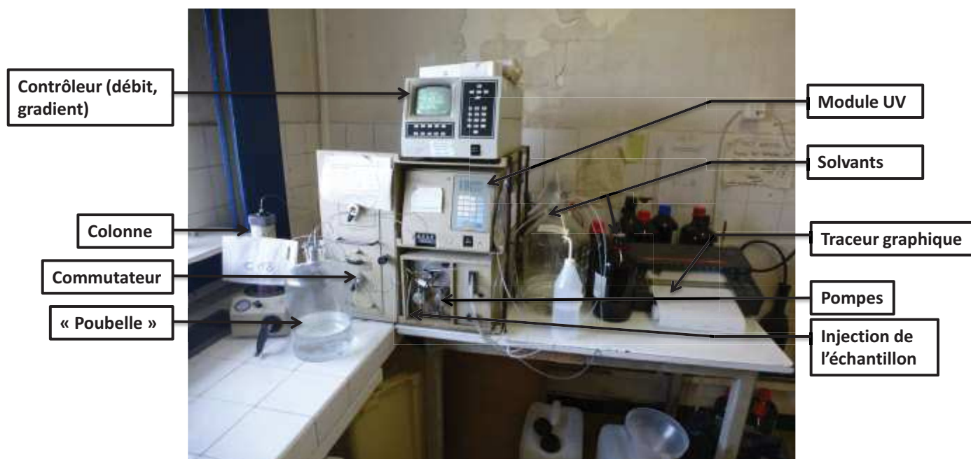
Illustration 6 : Photographie légendée de l'HPLC préparative manuelle
