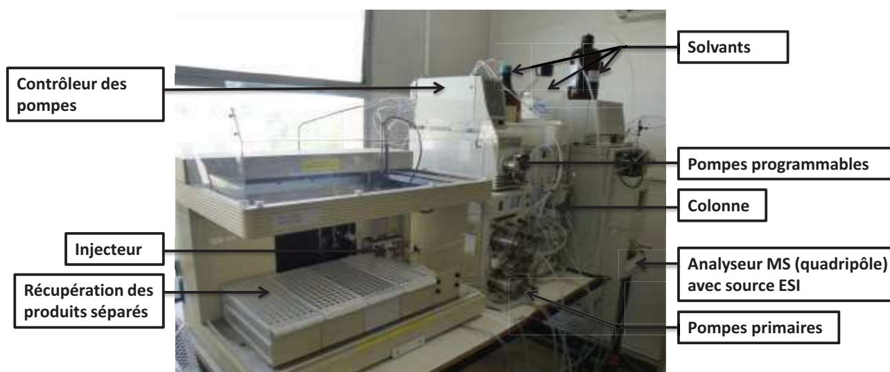
Illustration 7 : Photographie légendée de l'HPLC préparative automatique Waters
