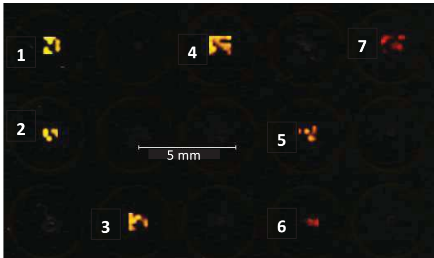
Figure 176 : Cliché d'imagerie représentant la répartition des deux peptides cocrystallisés lors de la mesure de la liaison non spécifique
