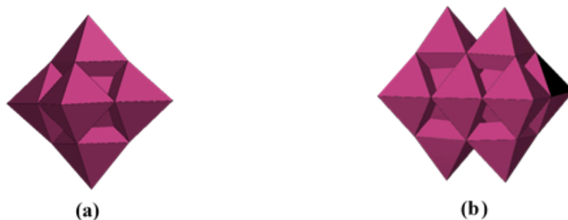
Figure 2. Structure polyédrique d'isopolyanions : (a) Lindqvist ; (b) Isopolyvanadate.
