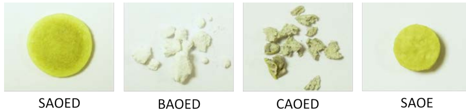
Figure 2.40 – Images des particules céramiques synthétisées par micro-onde : \text{SrAl}_2\text{O}_4 : Eu, Dy (SAOED), \text{BaAl}_2\text{O}_4 : Eu, Dy, (BAOED), \text{CaAl}_2\text{O}_4 : Eu, Dy (CAOED) et \text{SrAl}_2\text{O}_4 : Eu (SAOE).
