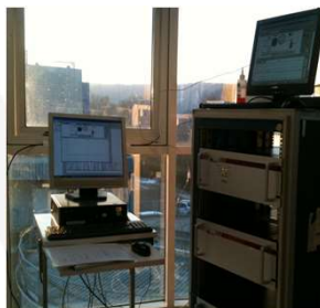
Chaînes GC-FID automatiques (AirmoVOC C 2 C 6 - AirmoBTX)
