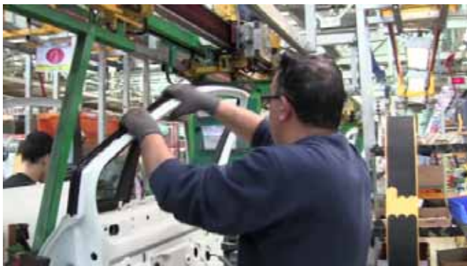
Figure 12 : Montage coulisse porte avant Clio IV - 2
