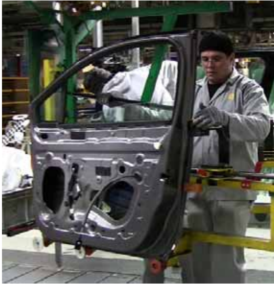
Figure 9 : Montage du lécheur – 1
