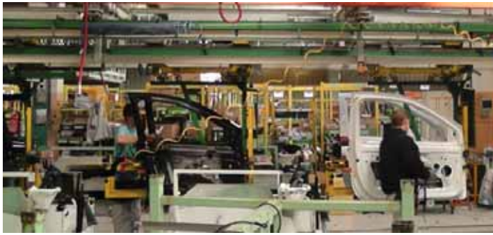
Figure 3 : Enchaînement des postes UET des portes
