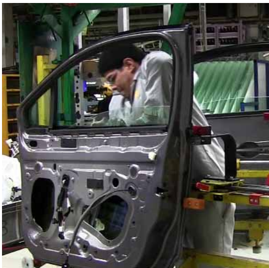
Figure 10 : Montage du lécheur - 2
