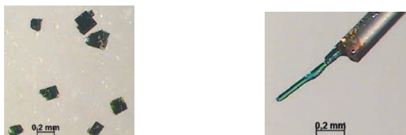
Figure 177 : Aspect physique des deux formes cristallines supposées du MoCu 4 : cubes (à gauche) et aiguilles (à droite)
