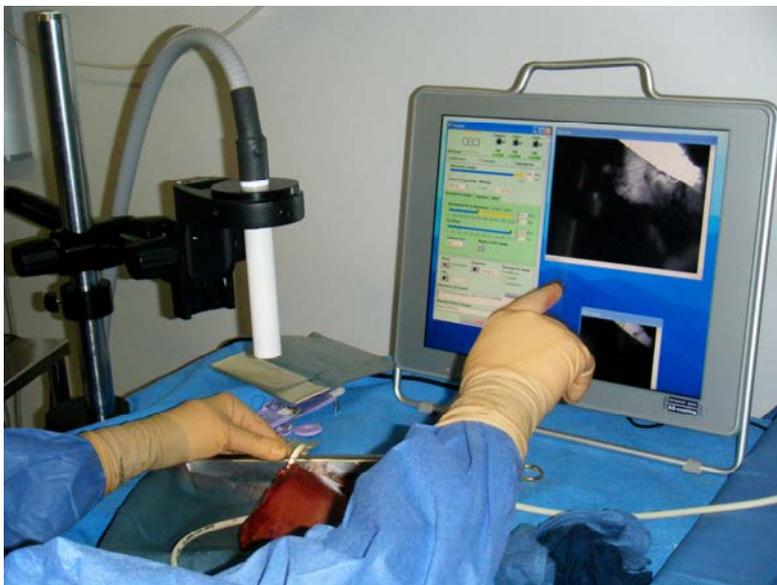
**Fig. 20.** Le prototype de la caméra NIR avec les premières images en temps réel fluorescentes au bloc opératoire lors de la perfusion d'ICG.
