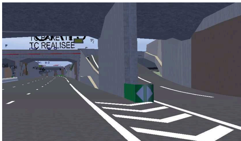
FIG. 8.11 – Exemple de modélisation d'un atténuateur de chocs.
