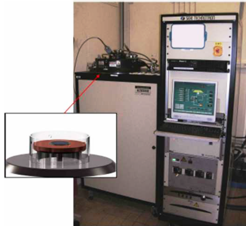
FIGURE 2.15 – Photographie du réacteur THOR de type AX6050X et de son enceinte.
