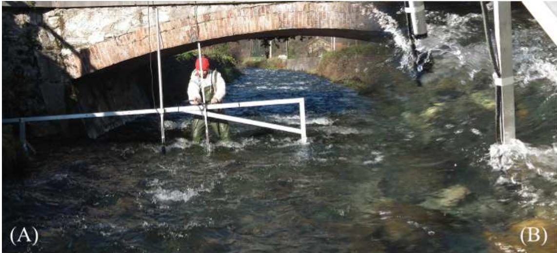
figure 2.1 : Photos du site du pont des moines dans le torrent du Domeynon. (A) Déploiement des hydrophones à l'aide d'une structure en Inox. L'état de rugosité de surface peut être observé par l'écume blanche des vagues. (B) Les hydrophones sont placés à la mi-hauteur de la colonne d'eau. L'immersion d'un objet dans le courant provoque des perturbations à la surface. On peut aussi observer le sillage turbulent présent derrière l'hydrophone.
