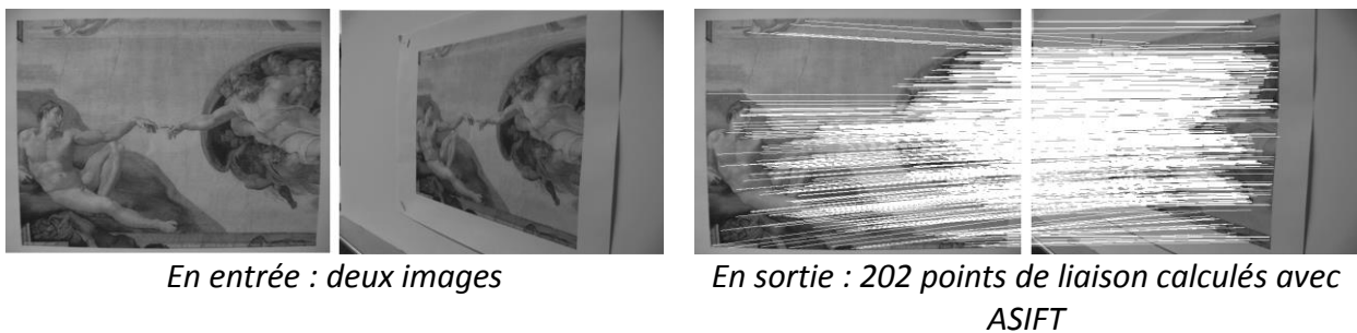
Figure 41 : Exemple du calcul de points de liaison avec ASIFT ( http://www.ipol.im )
