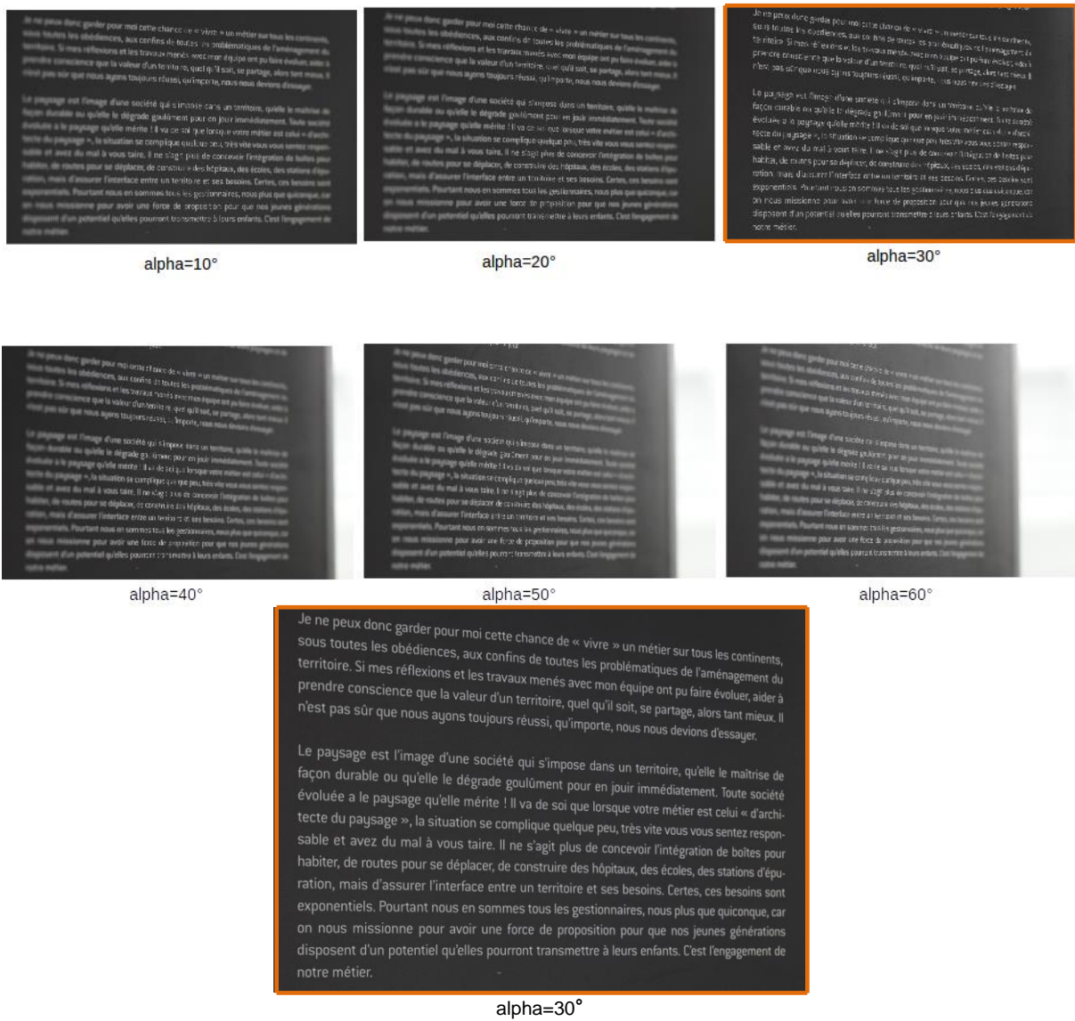
Figure 29 : Estimation du meilleur plan de netteté
