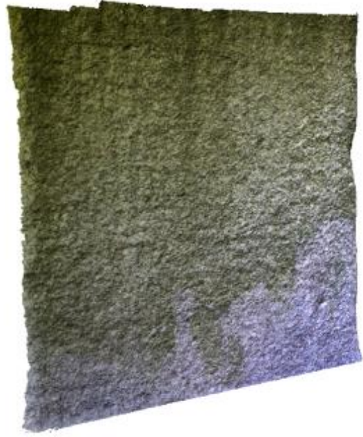
b) le nuage de points 3D calculé avec MicMac (Résolution : 0.4 mm, 2 879 646 points)
