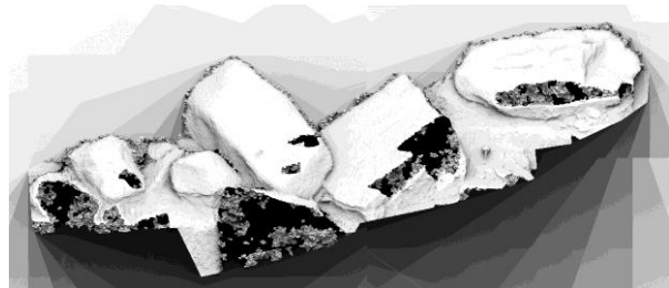
d. la carte de profondeur ombrée correspondante présente du bruit et des trous
