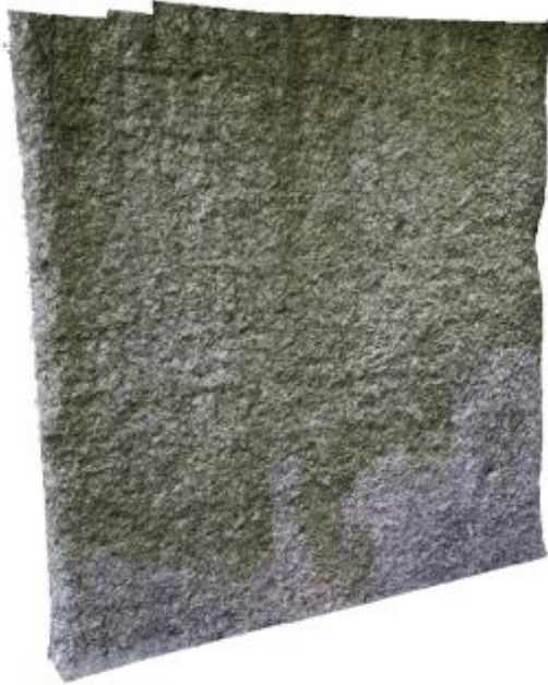
a) le nuage de points 3D calculé avec Photoscan (Résolution : 0.4 mm, 2 685 980 points)
