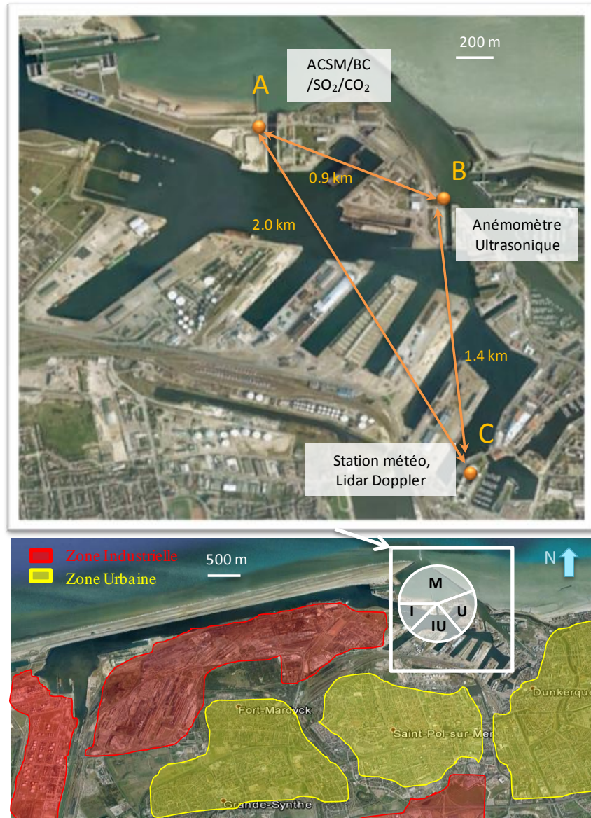
Figure 2-27 (Haut) Localisation des sites : (A) station de Port-Est, site des mesures chimiques ; (B) marégraphe, anémomètre ultrasonique ; (C) Bâtiment MREI, station météo et Lidar Doppler (Bas) M = secteur marin, U = secteur urbain, IU = secteur industriel-urbain, I = secteur industriel)
