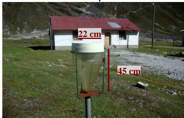
Figure II 2.- . a) Station météorologique typique de l'Altiplano et de la ville de La Paz. A droite : pluviomètre journalier cylindrique ayant une dimension de 22 cm de diamètre et 50 cm de hauteur. b) Pluviomètre journalier de forme conique typique de la vallée du Zongo ayant un diamètre de 22cm et une hauteur de 45 cm.
