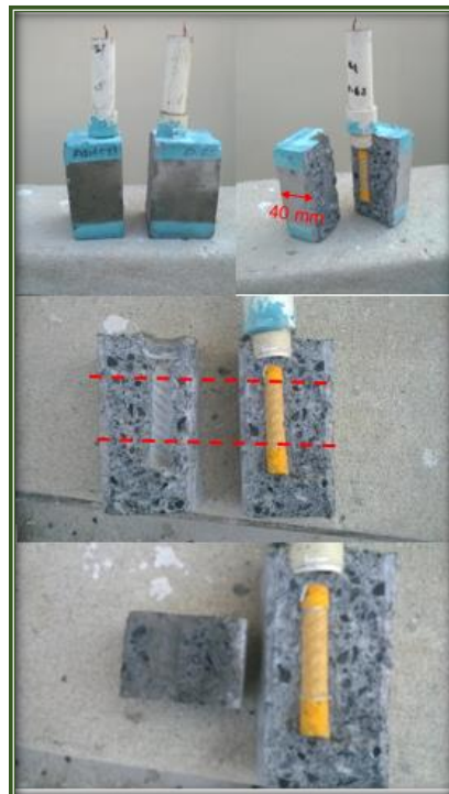
Fig. 51. Espécimen seccionado para recuperar una muestra de concreto en la proximidad de la interface varilla-concreto.
