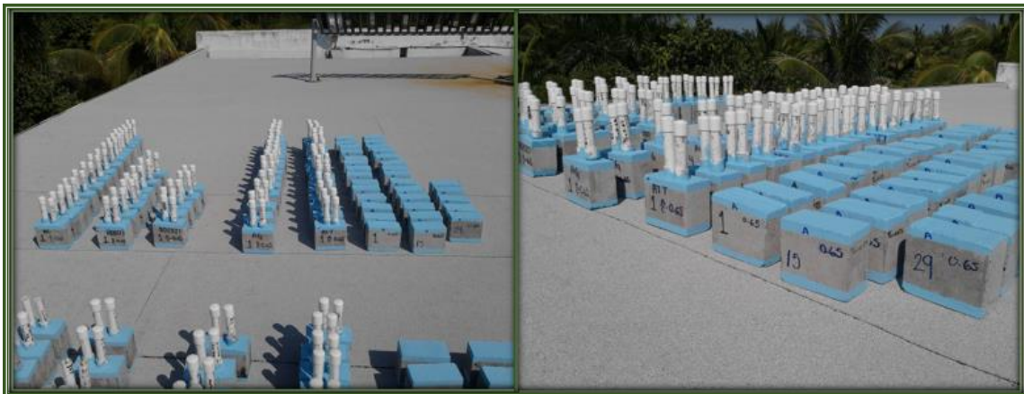
Fig. 45. Exposición de especímenes a ambiente marino.
