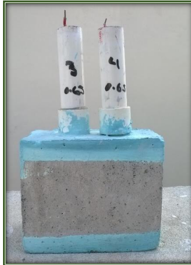
Fig. 34. Espécimen fabricado antes de su exposición a un medio agresivo.
