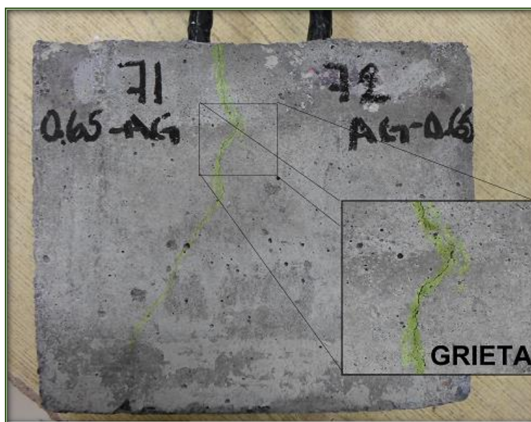
Fig. 84. Superficie de un espécimen de concreto agrietado expuesto a ambiente controlado en laboratorio: AG-0.65 (varilla de acero galvanizado-relación a/c=0.65).
