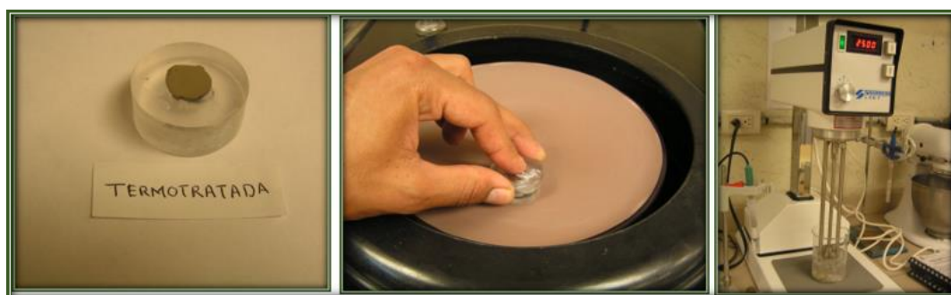
Fig. 22. Preparación de varillas antes del ensayo de microdureza por Vickers.
