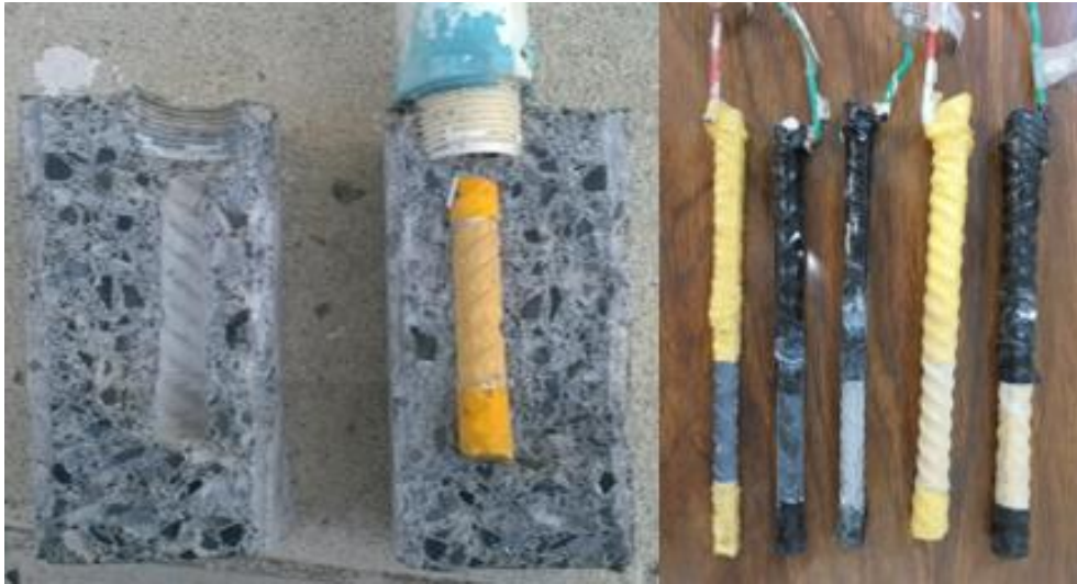
Fig. 68. Sección de un espécimen diseñado con protección al intemperismo y diferentes varillas extraídas sin presencia de daño en la interface varilla-concreto-ambiente.
