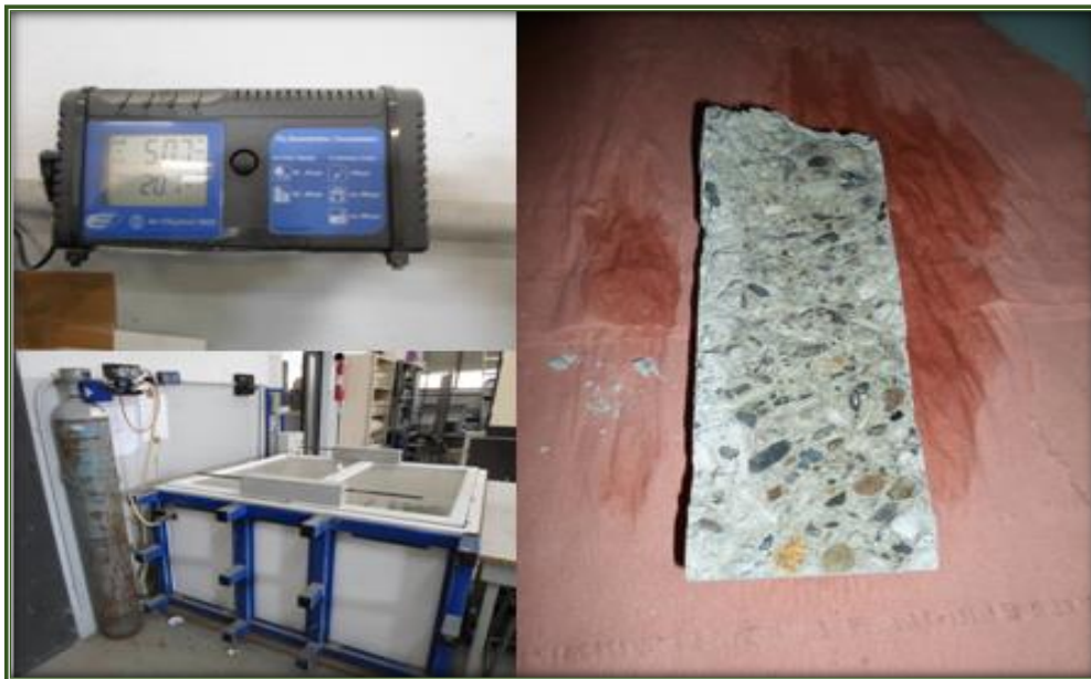
Fig. 39. Sistema de carbonatación y espécimen carbonatado totalmente.
