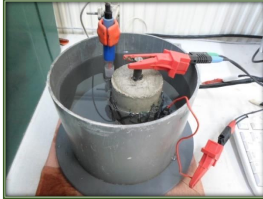
Figure 18 : Montage expérimental pour le tracé des courbes de polarisation et l'identification des paramètres de Tafel.
