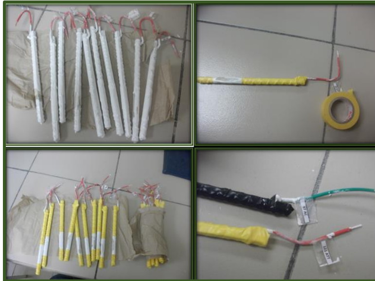
Fig. 28. Aplicación del recubrimiento con pintura epóxica y cinta de aislar.
