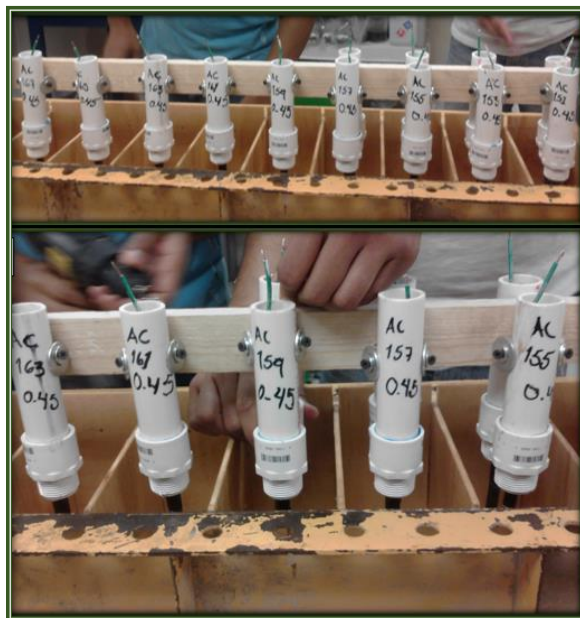
Fig. 32. Montaje de las varillas antes del colado del concreto.
