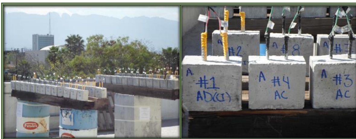
Fig. 47. Especímenes expuestos a ambiente urbano/industrial (azotea del IIC).
