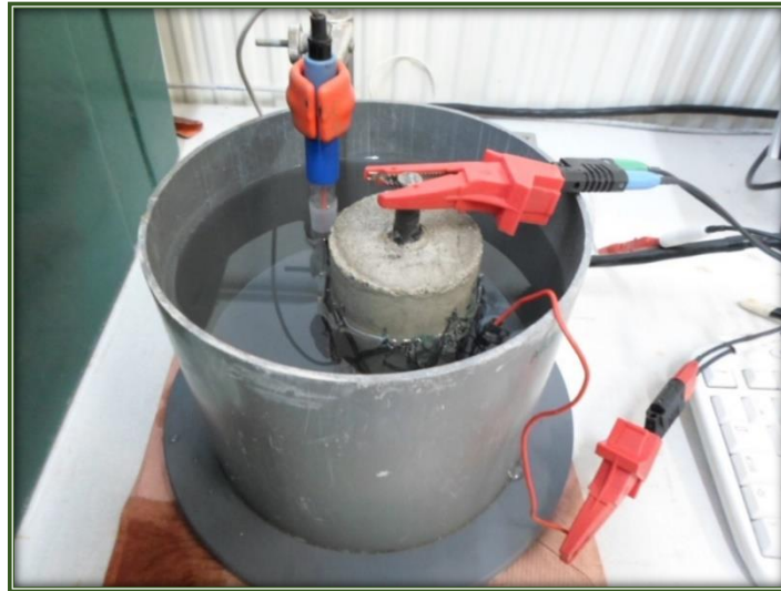
Fig. 54. Sistema de tres electrodos para la aplicación de la técnica de extrapolación de Tafel.
