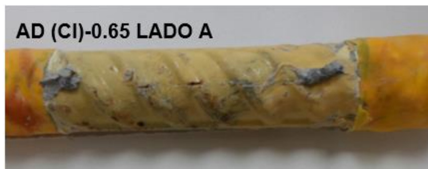
Fig. 95. Estado de la superficie localizada en el área de estudio de las varillas ADCl expuestas a ambiente controlado en laboratorio: relación a/c de 0.65.
