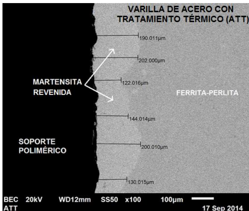
Fig. 58. Microestructura de la varilla ATT, composición física; ferrita-perlita y martensita.
