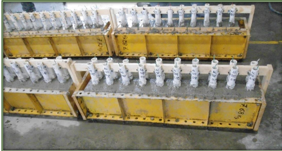
Fig. 33. Especímenes confinados en los moldes metálicos después del colado.
