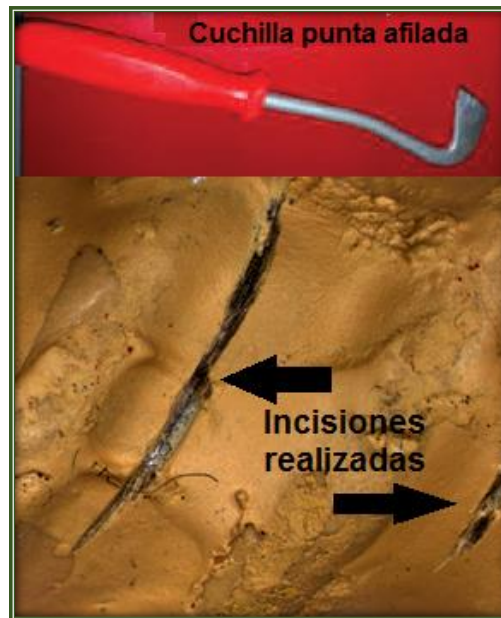
Fig. 30. Cuchilla e incisiones realizadas sobre la varilla de AD.
