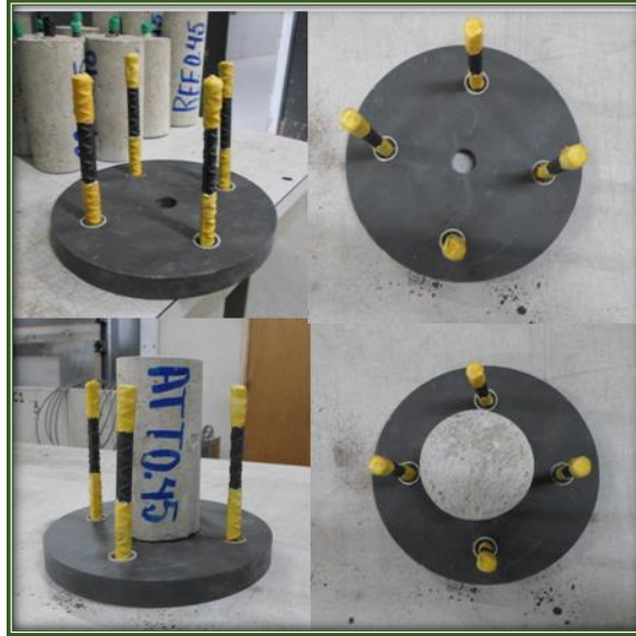
Fig. 41. Colocación de varillas y espécimen carbonatado
