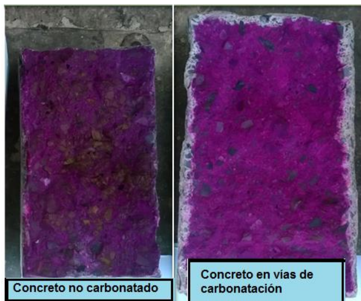
Fig. 53. Cambio de coloración de la fenolftaleína revelando el frente de carbonatación. Profundidad del frente de avance de carbonatación.
