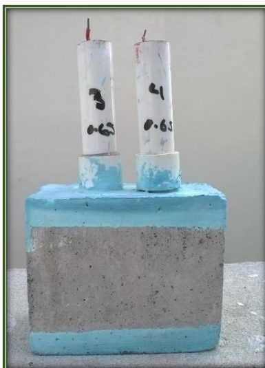
Figure 7 : Échantillon de béton armé soumis aux expositions agressives naturelles
