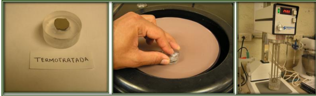
Figure 2 : Préparation des aciers pour la caractérisation de la microdureté
