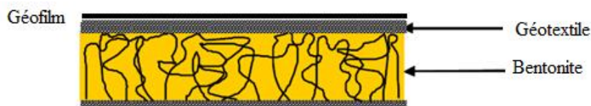
Figure I-7 : Schéma d'un géofilm bentonitique
