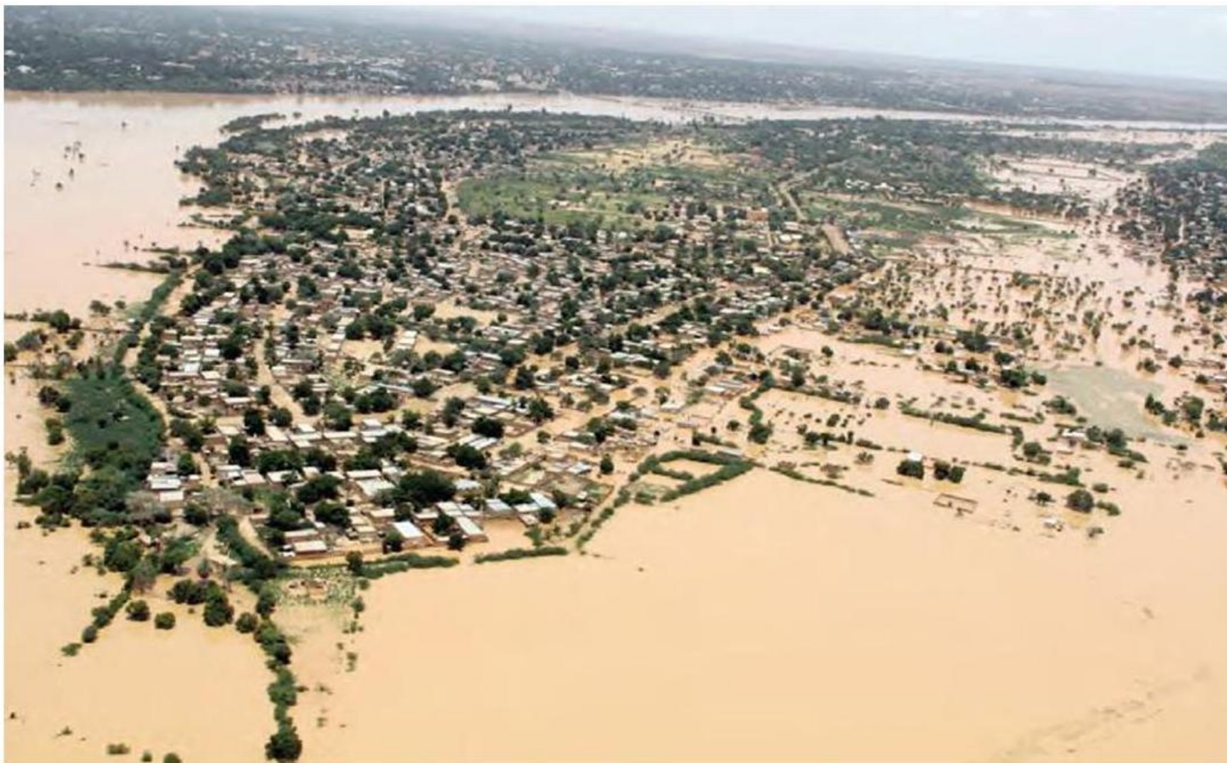
Figure 15. 10. Inondation d'un quartier situé sur la rive droite du fleuve Niger (quartier Lamordé, Niamey), en aout 2012. Cette crue résulte essentiellement de l'apport d'eau des affluents du fleuve situés en amont de Niamey que sont Gorouol, Dargol et Sirba. Source : © Photo Maurice ASCANI - www.photographe-niger.com
