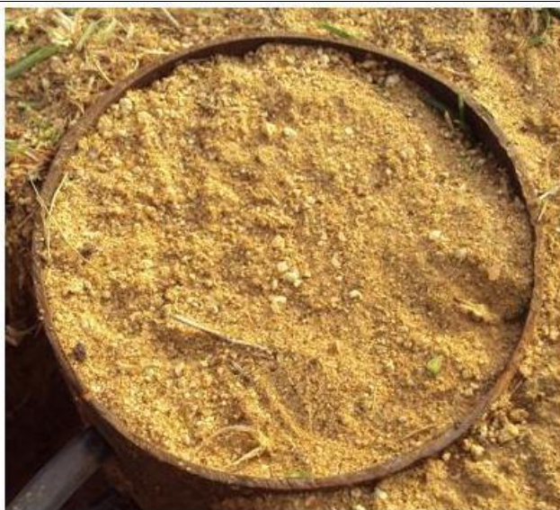
Cylindre installé sur ST
