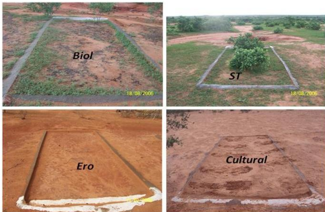
Figure 8.4. Parcelles de mesure du ruissellement sur le site du bassin sédimentaire (TK).
