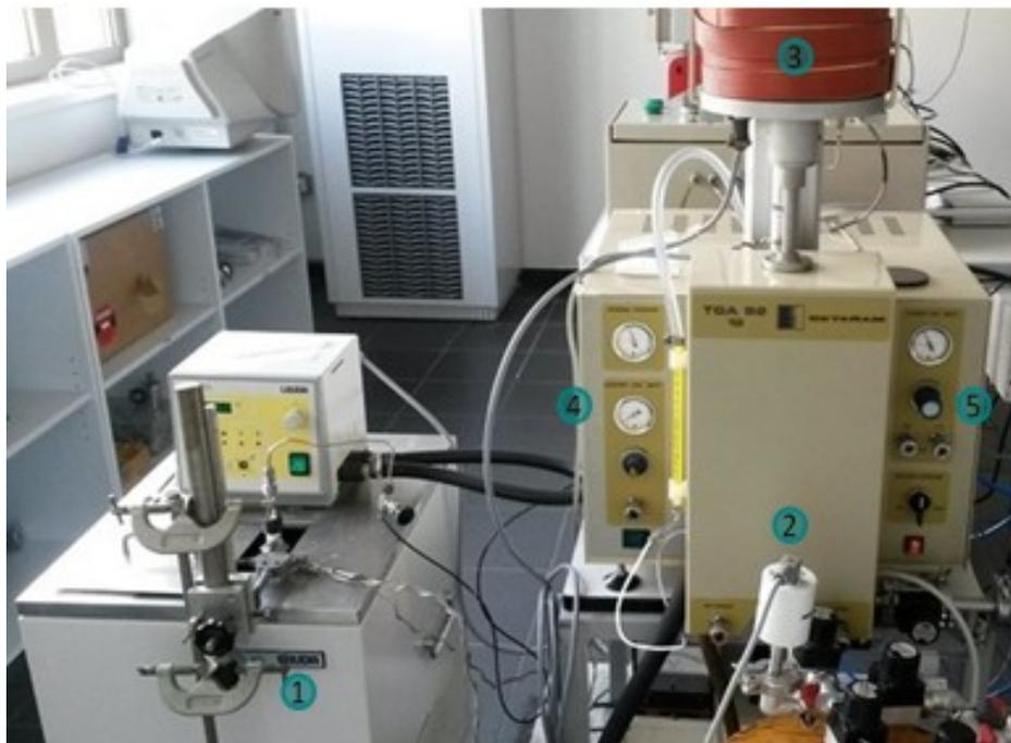
**Figure A1-4** : Photographie du montage permettant de réaliser les tests d'adsorption en phase gaz comprenant un bain thermostaté où se situe la cellule contenant les chlorobenzènes (1), un four (2), une balance (3), un gaz vecteur : diazote entraînant les vapeurs de chlorobenzènes (4), un gaz inerte : diazote balayant la balance et diluant le gaz vecteur (5)
