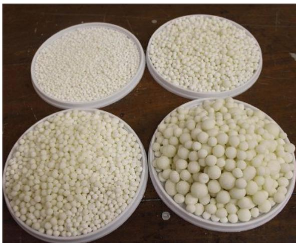
**Figure III-9** : Billes de MOF UiO-66(Zr) conçues à l'aide d'un mélangeur/granuleur[21]
