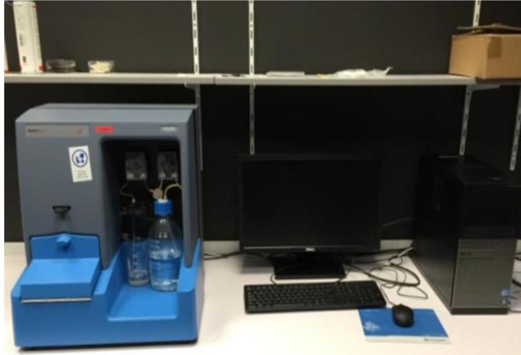
Figure 22 : Appareil Nanosight NS500 utilisé pour la détection des nanoparticules dans le milieu ISO 8692 (photo S. Cambier).
