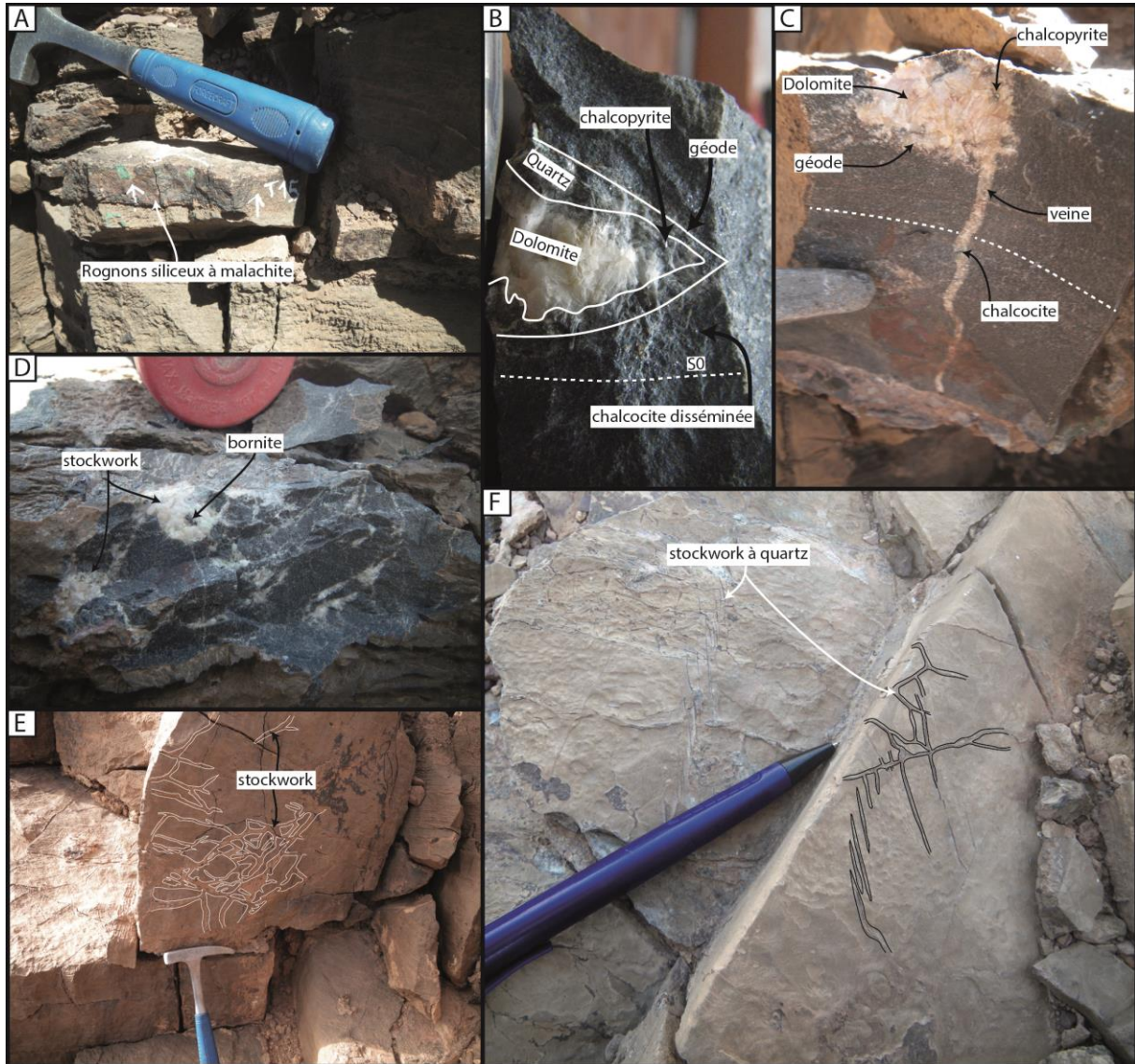
Figure 42 : Planche photographique montrant les différentes texture associées à la minéralisation de l'indice de Oued R'Them. A, rognons siliceux du niveau porteur présentant des mouches et fissures à malachite ; B, géode en amande parallèle à la stratification, au toit du niveau porteur minéralisé ; C, géode en amande parallèle à la stratification au toit du niveau porteur minéralisé et connectée à des veines sécantes sur la stratification ; D, E et F, stockwork à bornite au sein du niveau porteur.
