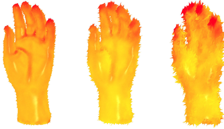
FIGURE 5.10 – moyenne des valeurs absolues des courbures sur les données “ceasar” estimées avec d_{P,k}^w -VCM (le jaune représente une courbure faible et le rouge une courbure forte). Paramètres : R = 0.04 , r = 0.02 , k = 30 . De gauche à droite, le bruit Hausdorff est 0.04, 0.08 and 0.16.
