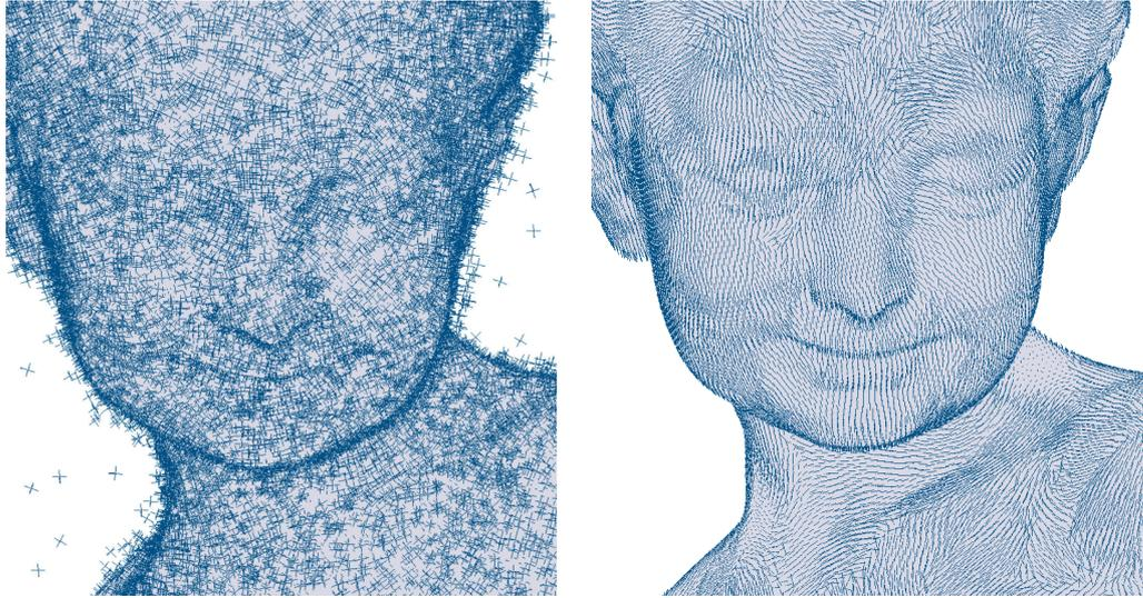
FIGURE 5.8 – Estimation des directions principales sur “Bimba”. Gauche : Données en entrée avec *outliers* (80% des points sont translatisés d’une distance au plus 0.02, 10% sont translatisés d’une distance entre 0.02 et 0.1, et 10% sont des *outliers* pris uniformément dans une boîte englobante). Droite : pour chaque point, on projette l’estimation de la direction principale minimale du  $d_{P,k}^w$ -VCM sur la triangulation initiale.
