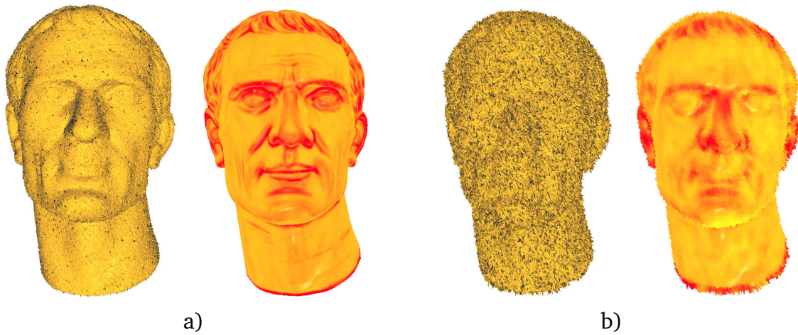
FIGURE 5.9 – moyenne des valeurs absolues des courbures sur les données “cesar” estimées avec le d_{P,k}^w -VCM (le jaune représente une courbure faible et le rouge une courbure forte). Paramètres R = 0.04 , r = 0.04 , k = 30 . De gauche à droite : donnée en entrée avec un bruit Hausdorff = 0.02 ; estimation des courbures correspondantes ; donnée en entrée avec un bruit Hausdorff = 0.06 ; estimation des courbures correspondantes.
