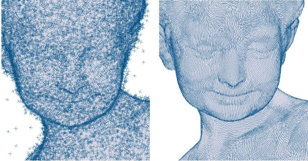
FIGURE 4 – Estimation des directions principales sur “Bimba”. Gauche : Données en entrée avec *outliers* (80% des points sont translatés d’une distance au plus 0.02, 10% sont translatés d’une distance entre 0.02 et 0.1, et 10% sont des *outliers* pris uniformément dans une boîte englobante). Droite : pour chaque point, on projette l’estimation de la direction principale minimale du VCM généralisé sur la triangulation initiale.
