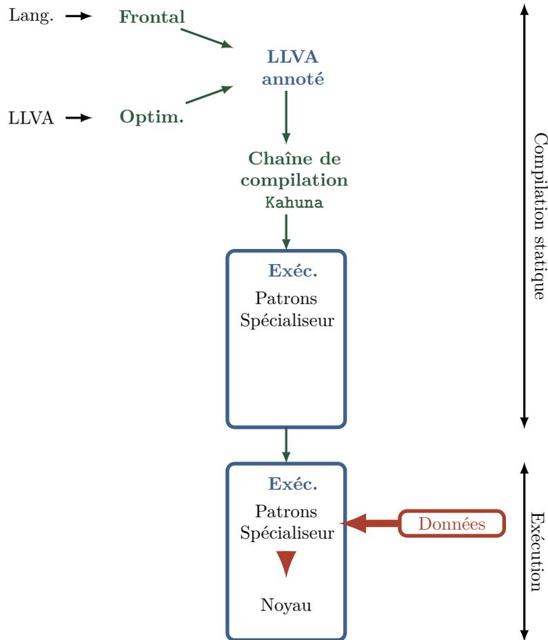
FIGURE 4.2 – Principe de fonctionnement de Kahuna.
