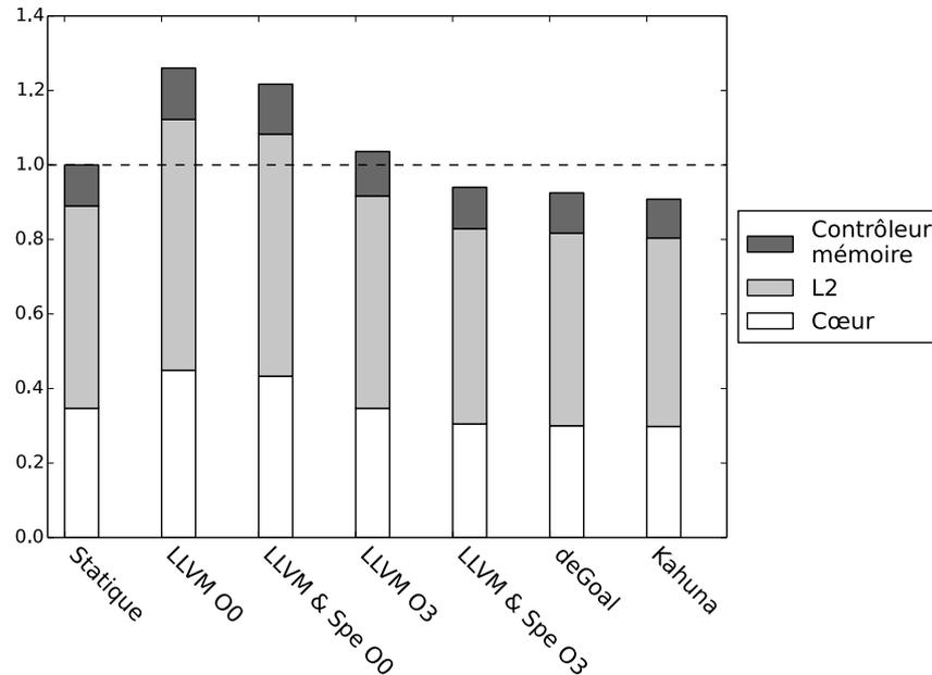
FIGURE 6.6 – Consommation énergétique des noyaux générés par composant du processeur. Les valeurs sont mises à l’échelle par rapport à la version `statique`. Les valeurs les plus faibles sont les meilleures.
