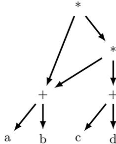
FIGURE 2.4 – Exemple de graphe orienté acyclique : représentation de l’expression  $(a + b) * (b + a) * (c + d)$ .
