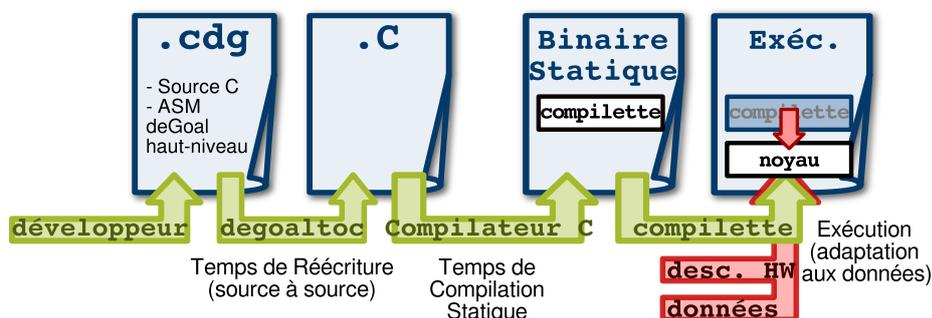
FIGURE 4.1 – Processus de compilation de deGoal (illustration de D. Couroussé).
