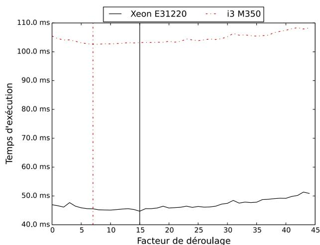
FIGURE 3.3 – Vitesse d’exécution du noyau 3.1 compilé avec clang 3.4 et avec différents facteurs de déroulage pour l’option `-force-vector-unroll`. Les lignes verticales montrent le point optimal de déroulage pour les deux architectures.
