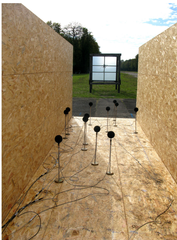
(c) Photo des microphones disposés dans l'environnement réverbérant le 30 octobre 2014.
