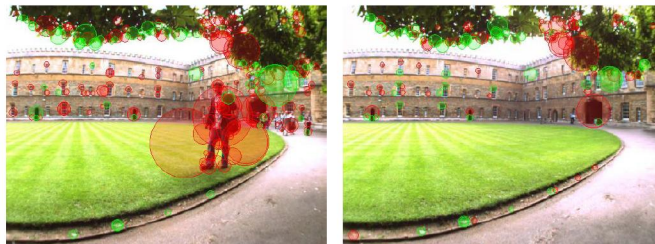
FIGURE 2.4 – Illustration du problème appelé perceptual variability : deux caméras photographiant une scène à deux instants différents donnent deux images non similaires. Figure réalisée par M.Cummins and P. Newman.
