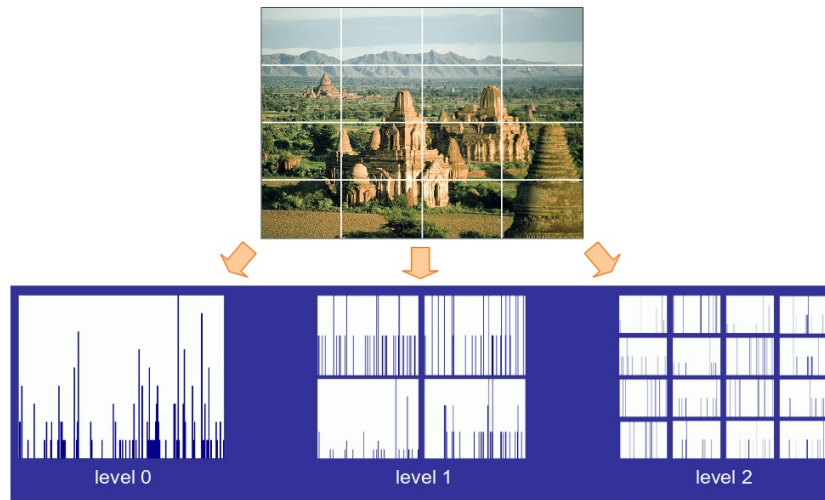
FIGURE 4.7 – Principe du calcul d’un sac de mots avec information spatiale. Figure réalisée par S. Lazebnik.
