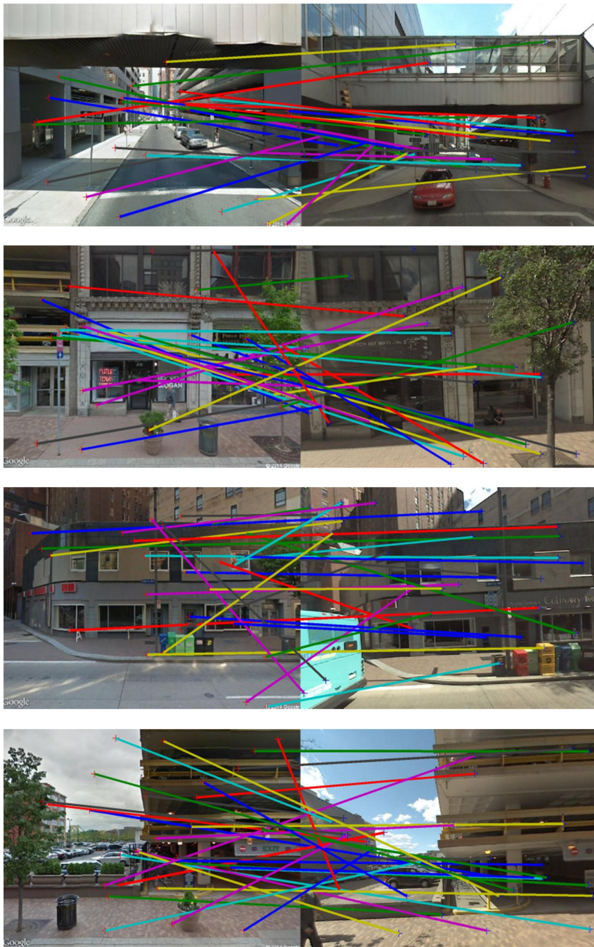
FIGURE 3.2 – Appariement de points : Exemples d’images difficiles pour lesquelles les points appariés sont pour la plupart faux.
