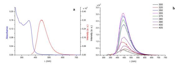
**Figure 8.** a) Spectres d'absorption (bleu) et d'émission (rouge) des Si NPs avec une terminaison amine (méthode hydrothermale) dans l'eau ( $\lambda_{exc} = 355$  nm); b) spectres d'émission à différentes longueurs d'ondes d'excitation de les mêmes Si NPs (les longueurs d'ondes d'excitation sont rapportées, en nm, en haut à droite)
