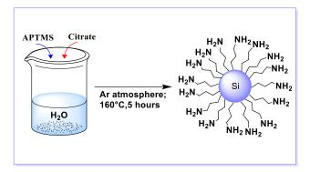
Figure 6. Approche synthétique pour la synthèse hydrothermale des nanoparticules de silicium terminées amine; [APTMS par un groupement = (3aminopropyl)trimethoxysilane; citrate Trisodium 2-hydroxypropane-1,2,3-= tricarboxylate]
