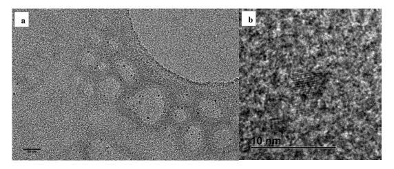
Figure 7. a) Images HR-TEM des Si NPs avec une terminaison amine obtenues par synthèse hydrothermale ; b) une nanoparticule montrant les franges cristallines du silicium.
