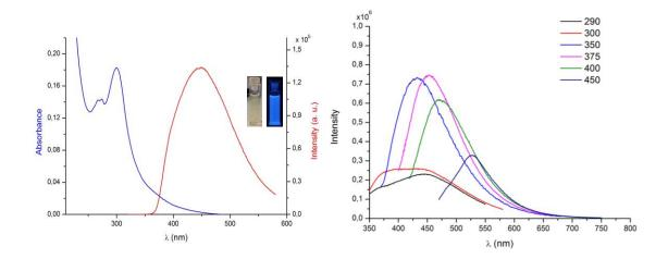
**Figure 5.** a) Spectres d'absorption (bleu) et d'émission (rouge), dans l'eau, des nanoparticules de silicium (méthode de microémulsion) avec une terminaison amine ( $\lambda_{exc} = 300$  nm; filtre 350 nm); encadré: photos de la solution dans des conditions ambiantes (à gauche) et sous irradiation UV (à droite); b) spectres d'émission à différentes longueurs d'ondes d'excitation de les mêmes Si NPs (les longueurs d'ondes d'excitation sont rapportées, en nm, en haut à droite)
