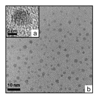
**Figure 4.** Images HR-TEM de Si NPs fonctionnalisées par un groupement amine, obtenues par la méthode de microémulsion ; a) nanoparticule isolée montrant les franges du réseau, caractéristiques des nanocristaux de silicium.
