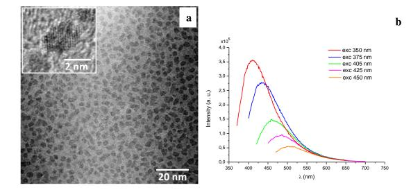
**Figure 9. a)** Images HR-TEM de CQDs; l'encadré montre une image à grossissement élevé d'une seule particule; **b)** spectres d'émission de CQDs dans l'éthanol à différentes longueurs d'onde d'excitation (les longueurs d'ondes d'excitation sont rapportées en haut à droite).
