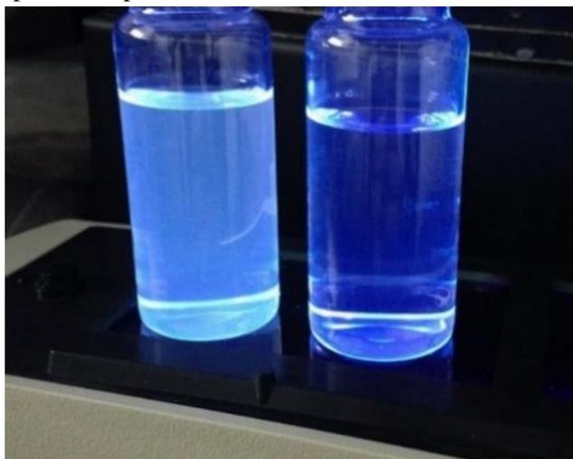
**Figure II-4** Photographie de deux solutions sous excitation UV à  $\lambda = 365$  nm : sur la gauche une solution post-synthèse et sur la droite une solution de cyclohexane pure
