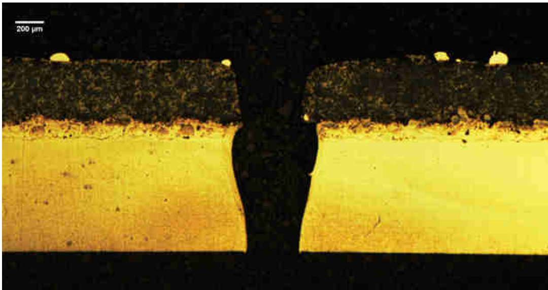
FIGURE C.1: Coupe transversale d'un échantillon de superalliage de cobalt revêtu de céramique percé à l'aide d'une impulsion laser de 10\ \text{kW} et de 1,30\ \text{ms} . Le faisceau laser est focalisé à la surface de la céramique avec un diamètre sur cible de 300\ \mu\text{m} .
