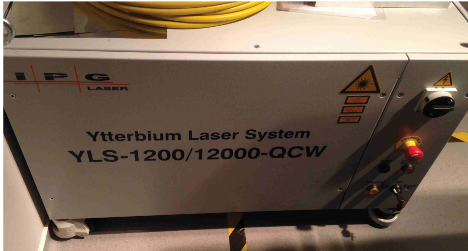
FIGURE 3.1: Bâti du laser à fibre d'IPG (modèle YLS-1200/12000-QCW) contenant les différents modules de diodes de pompe.
