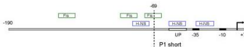
Figure 4.5. Comparaison des versions longue et courte du promoteur rrnBPI (dénommé P1 sur la figure). La version longue comprend les sites de fixation de la protéine Fis ; il s'agit de la séquence allant de -190 à +7 sur le schéma. La version courte – appelée « short » – exclut les sites de fixation de la protéine Fis et un site de fixation de la protéine H-NS ; il s'agit de la séquence allant de -69 à +7 sur le schéma.
