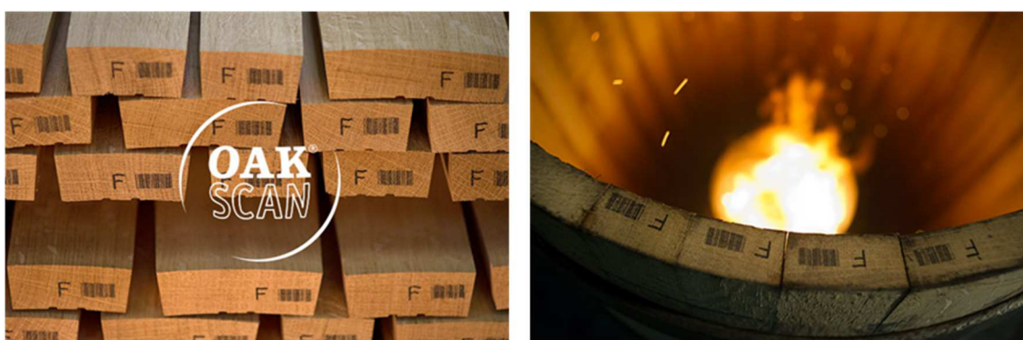
Figure 9 Marquage et sélection des douelles classées par OakScan®
