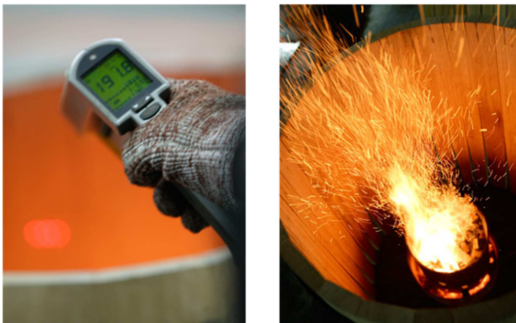
Figure 6 Contrôle de l'évolution des températures au cours de la chauffe
