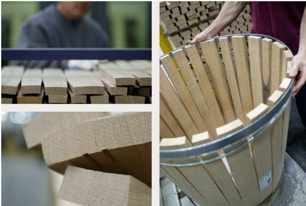
Figure 4 Sélection des douelles et étape de mise en rose d'une barrique
