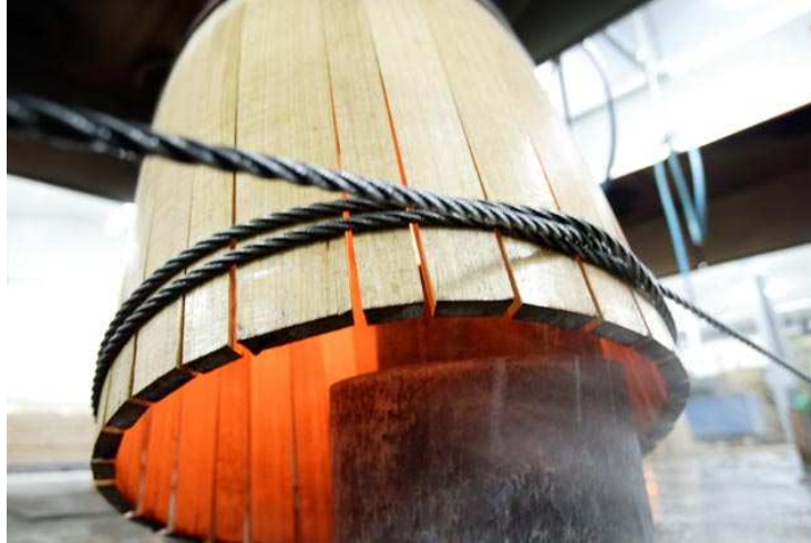
Figure 5 Préchauffage et cintrage de la coque
