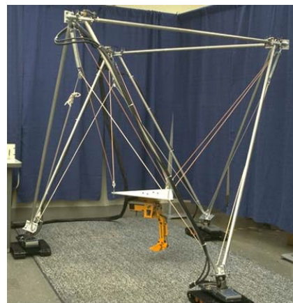
(b) Robot RoboCrane du NIST à 6 câbles et 6 degrés de liberté en configuration suspendue
