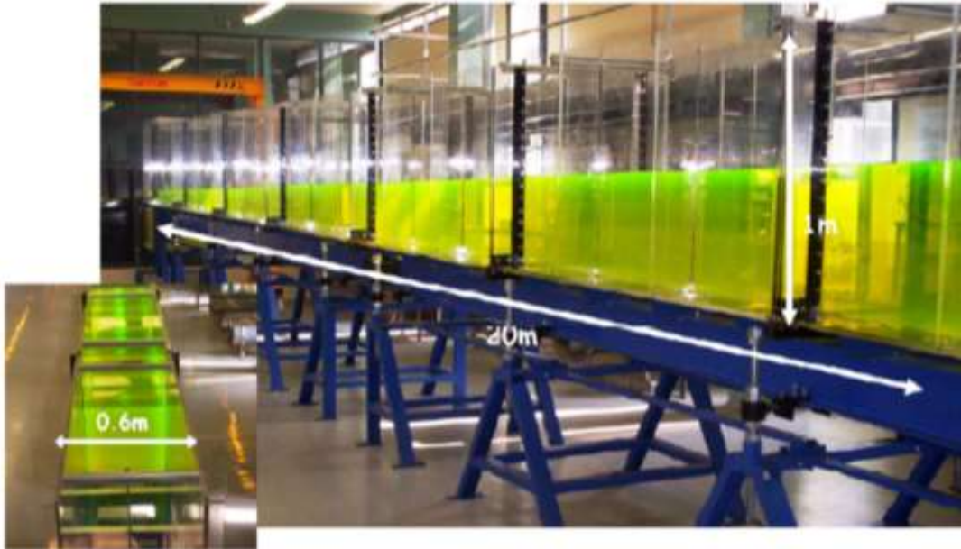
Figure 97. Schéma et photo du canal expérimental
