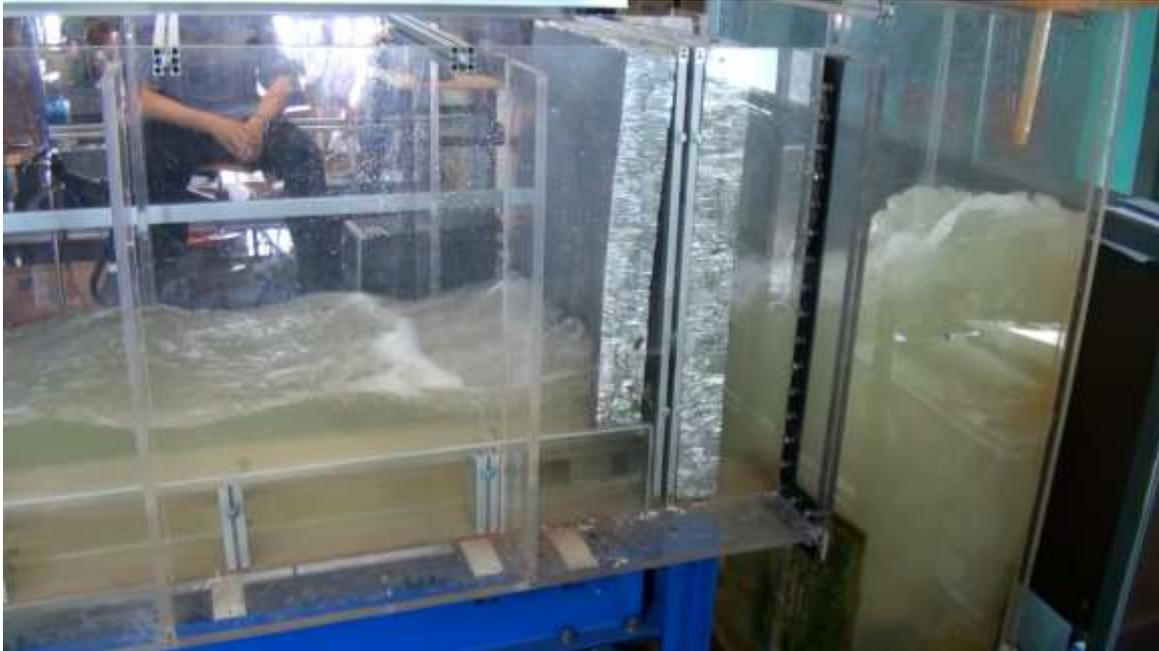
**Figure 108. Écoulement après l'installation de la deuxième plaque de nids d'abeilles**
