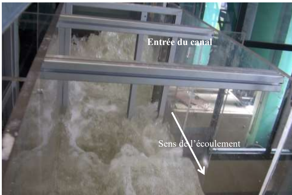
Figure 105. Turbulence générée par l'entrée du canal
