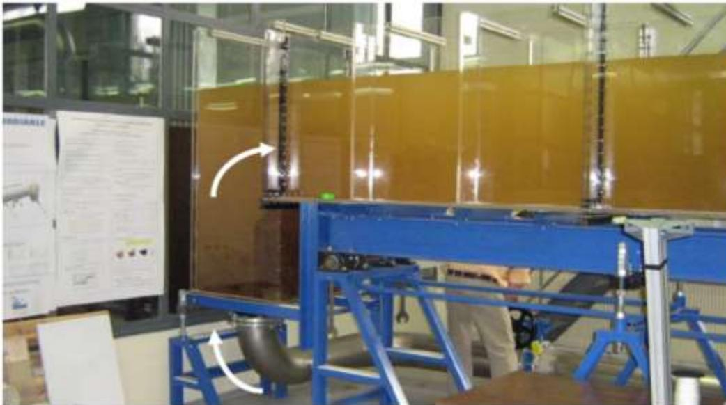
**Figure 99. Alimentation du canal par débordement**
