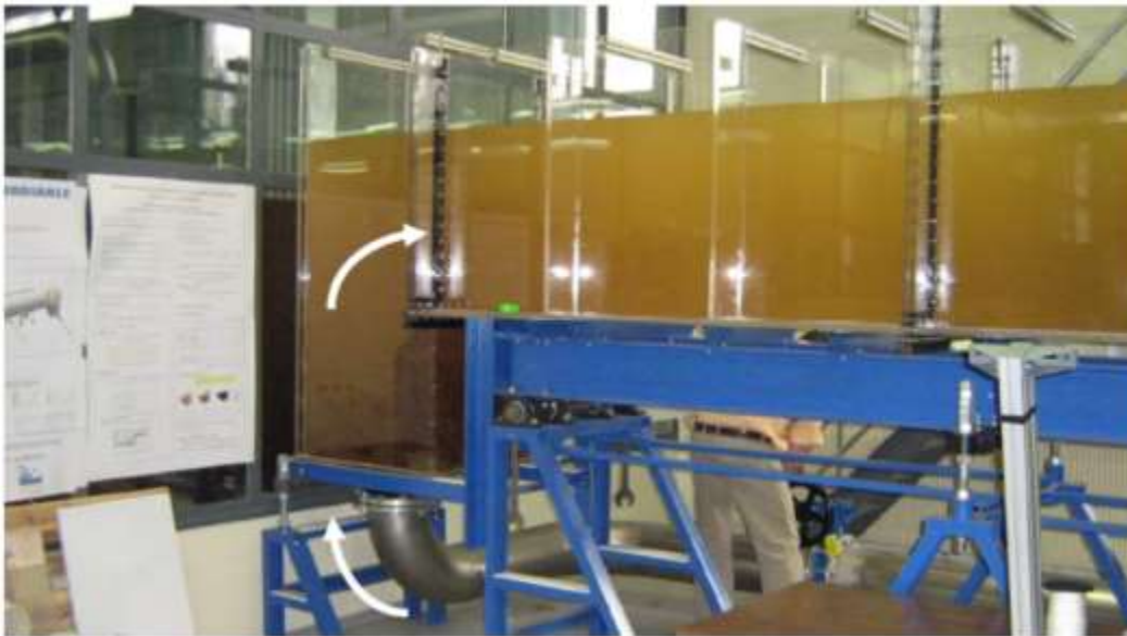
Figure 99. Alimentation du canal par débordement
