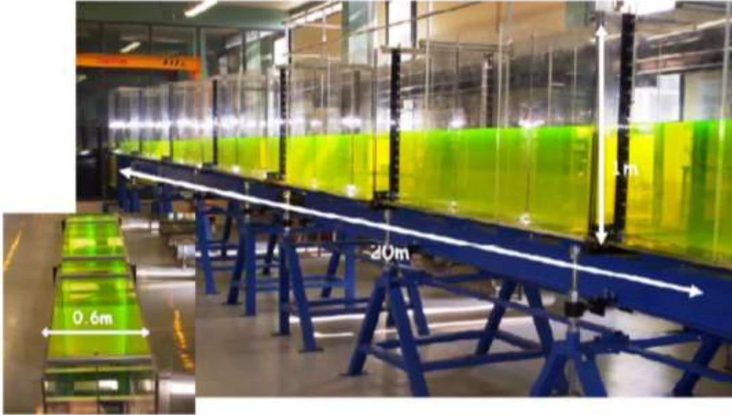
Figure 97. Schéma et photo du canal expérimental
