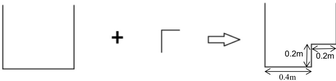
Figure 101. Installation d'une banquette dans le canal expérimental
