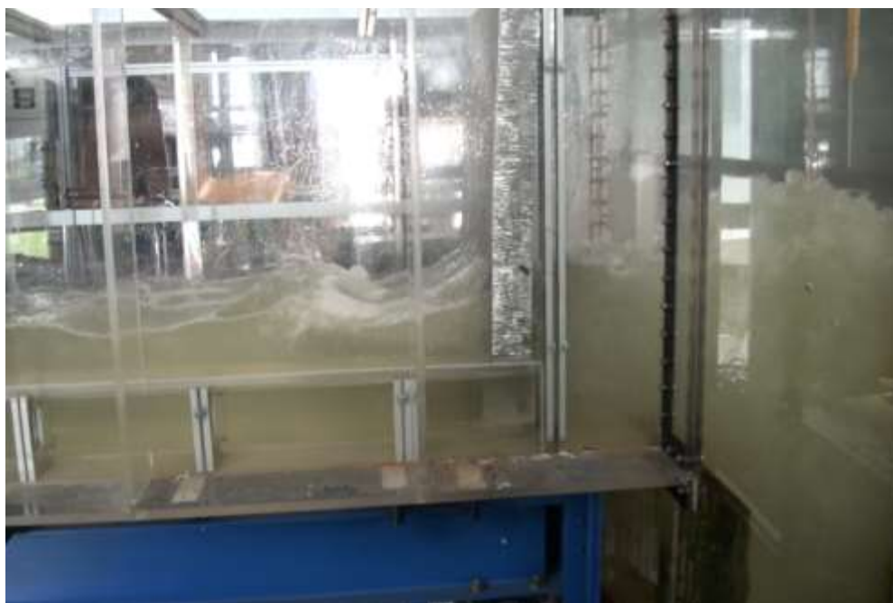
Figure 107. Écoulement après l'installation des nids d'abeilles.
