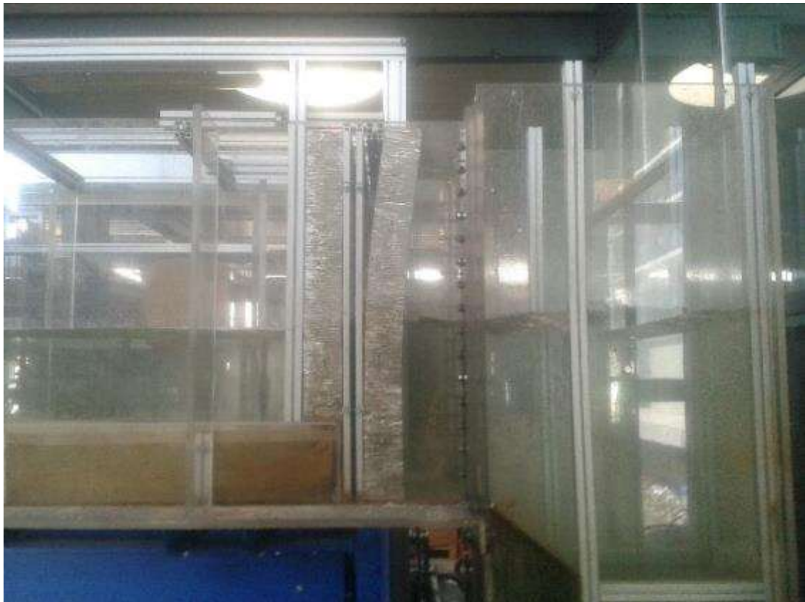
Figure 111. Écoulement après l'installation du dispositif de stabilisation
