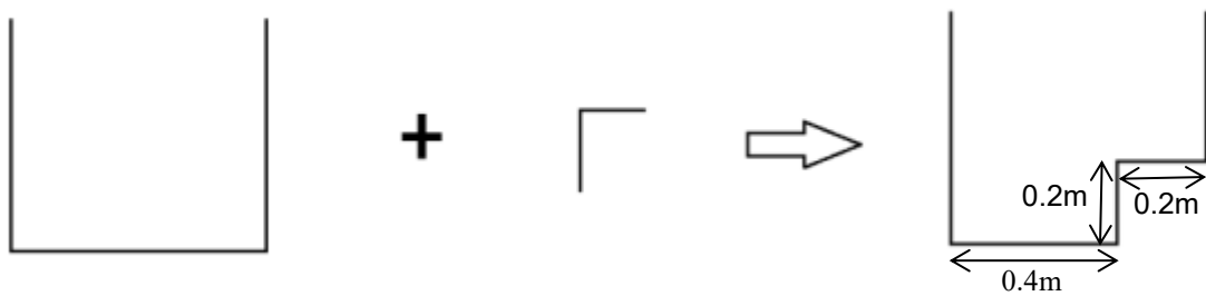
Figure 101. Installation d'une banquette dans le canal expérimental
