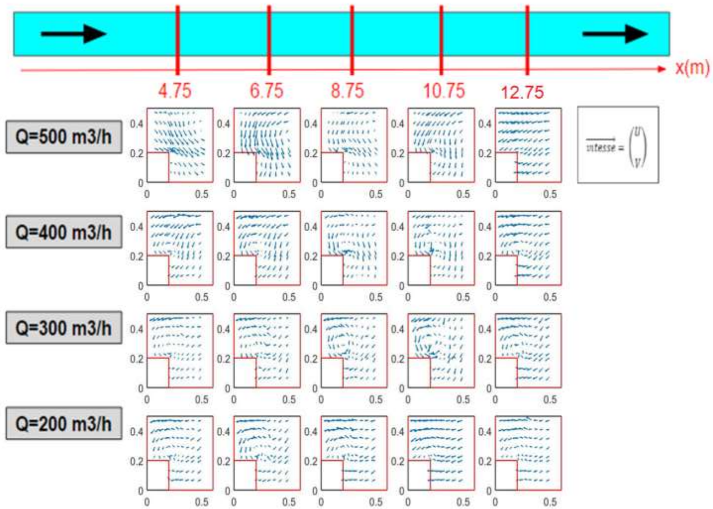
Figure 117. Courants secondaires après correction du tangage du capteur
