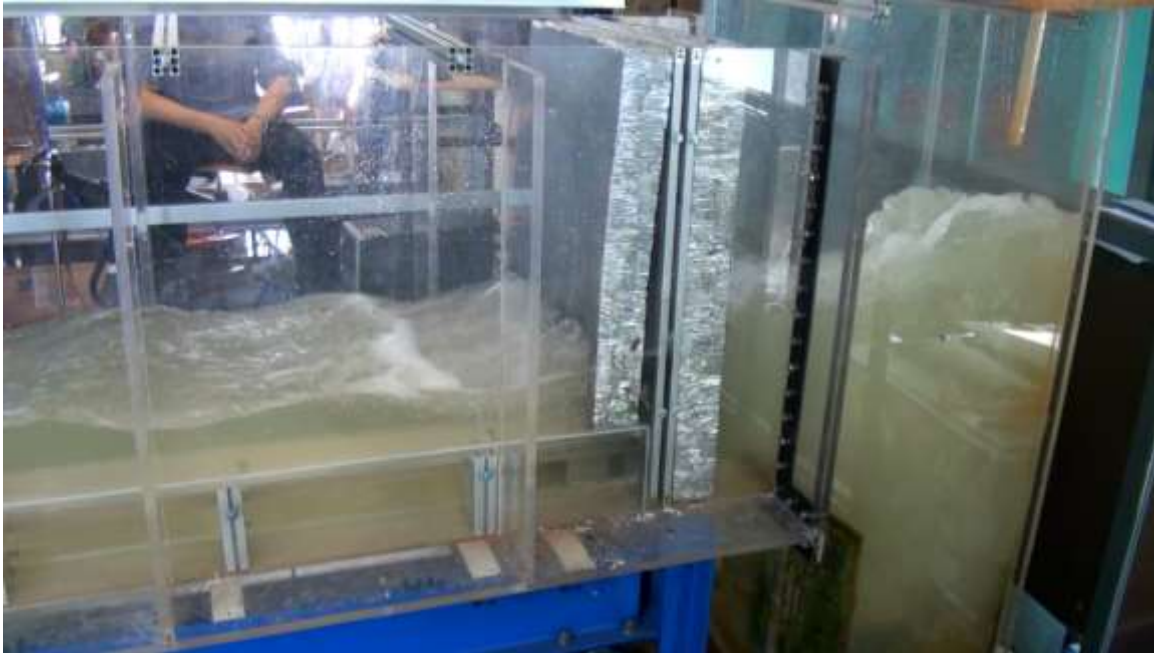
Figure 108. Écoulement après l'installation de la deuxième plaque de nids d'abeilles
