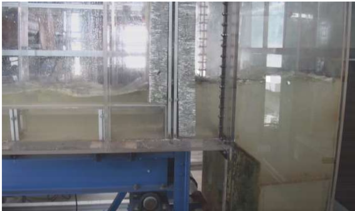
Figure 109. Écoulement après installation de la plaque de régulation
