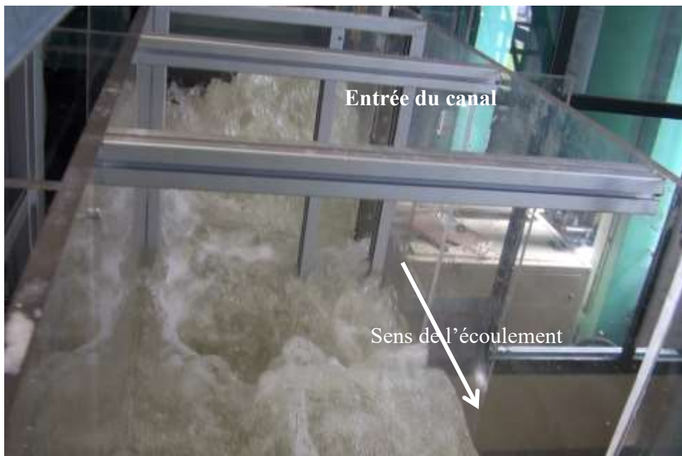
Figure 105. Turbulence générée par l'entrée du canal
