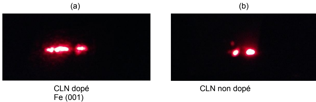
Fig. III.15 : Forme du faisceau rouge à la sortie du cristal. La figure (a) pour un CLN non dopé et (b) pour un CLN dopé fer (code 001 dans le Tableau III.1).
