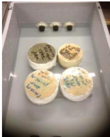
Figure 0-6. Photographie des éprouvettes en semi-immersion, dans les bacs contenant les solutions salines.
