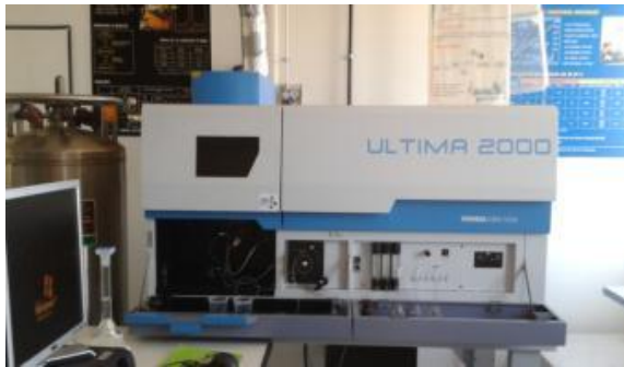
Figure 0-11. Spectrométrie par torche à plasma ; laboratoire CPDM-IFSTTAR
