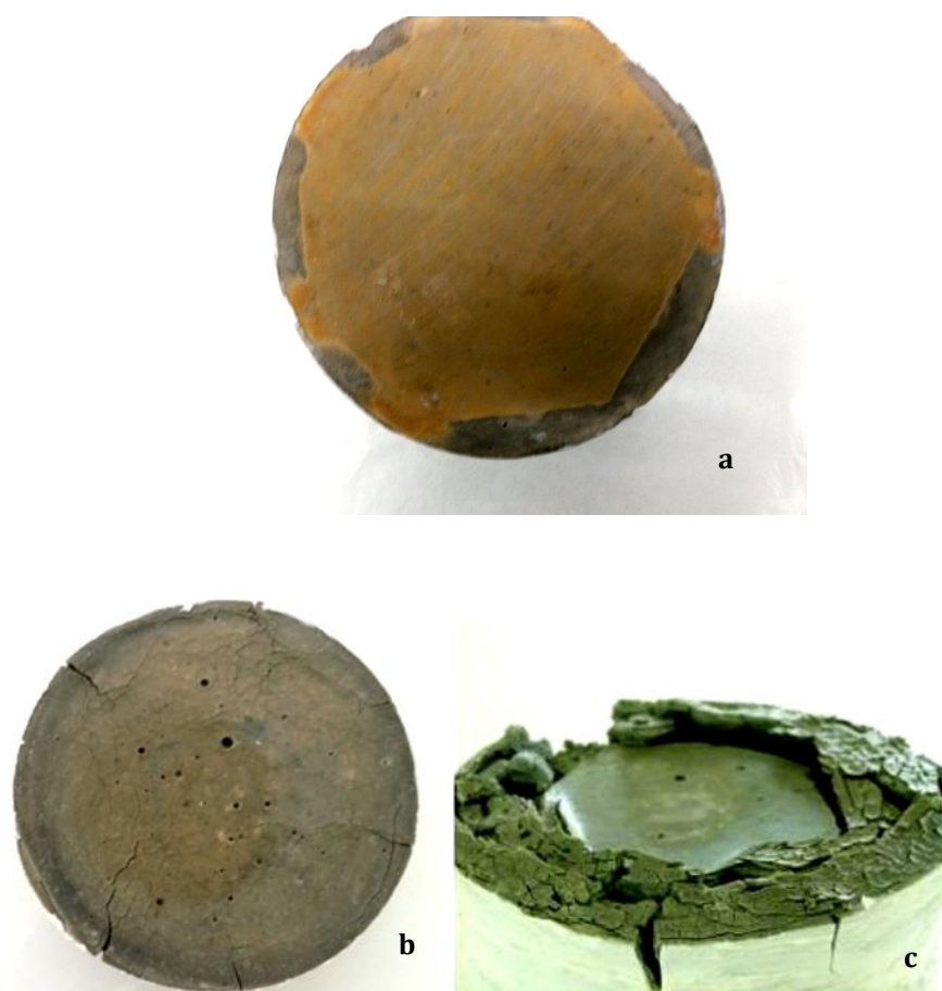
Figure 0-7 : Suivi visuel par photographie de l'évolution de la dégradation de la pâte de ciment PCO à E/C = 0,60 ; (a) : pâte de ciment PCO-0,60-JA exposée dès le jeune âge et durant 3 mois à la solution de sulfate de sodium. (b) pâte de ciment PCO-0,60 1an de cure saine + 2 mois SO_4 , (c) PCO-0,60 1an de cure saine + 3 mois SO_4
