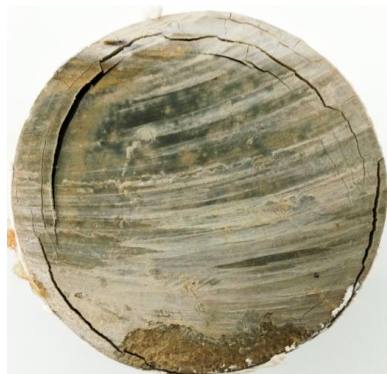
Figure 0-4 : Fissurations longitudinales partant du bord du disque de pâte de ciment PCL-0,45-JA, après 1 an de contact avec la solution de sulfate de sodium.
