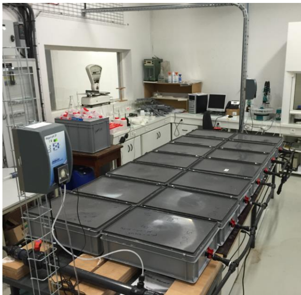
Figure 0-8. Schéma (en haut) et photo (en bas) du dispositif de contrôle et de régulation du pH développé dans le cadre de cette étude.
