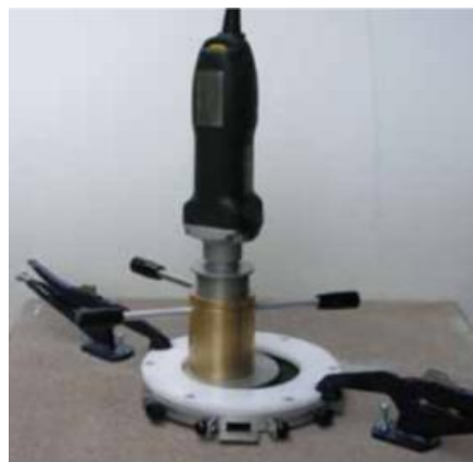
Figure 0-9. Profile Grinder utilise pour le broyage des pâtes de ciment
