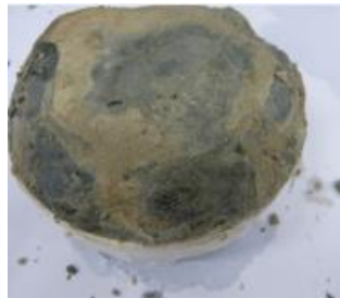
Figure 0-10 : Suivi visuel par photographie de l'évolution de la dégradation de la pâte de ciment, (a) pâte de ciment PCO-0,45-1an de cure saine + 2 mois SO 4 , (b) PCO-0,45-1an de cure saine + 6 mois SO 4 , (c et d) PCO-0,45-1an de cure saine + 8 mois SO 4
