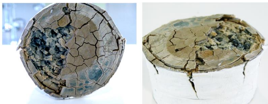
Figure 0-2 : Ecaillage totale de la surface exposée (perte de cohésion totale) de la pâte de ciment PCL-0,60-JA, avec évolution des fissures transversale à des fissures traversantes en profondeur, après 1 an de contact avec la solution de sulfate de sodium.
