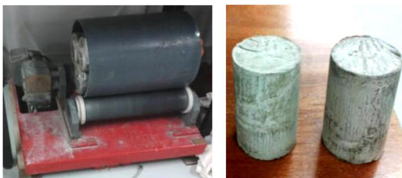
Figure 0-2 Dispositif anti-ressuage et anti-ségrégation utilisé pour la confection et des pâtes de ciment obtenues après démoulage.
