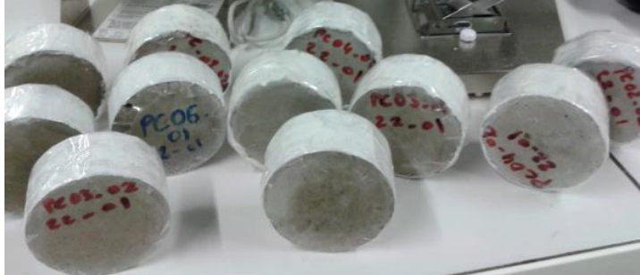
Figure 0-4 Disques confectionnés à partir des pâtes de ciment, avant mise en contact avec le milieu salin, périphérie protégée par une résine époxy.
