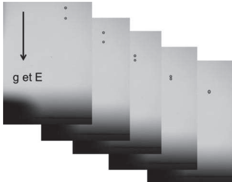
Fig B.29. Chute d'une paire de goutte dans l'huile modèle. Deux gouttes tombent dans l'huile modèle verticalement, se rapprochent et coalescent sous l'effet du champ électrique.
