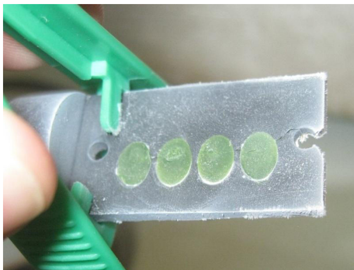
Figure 12 : Quatre échantillons d'algues exposées au cobalt disposés dans un porte échantillon adapté à l'analyse sur la ligne de lumière BM30b de l'ESRF
