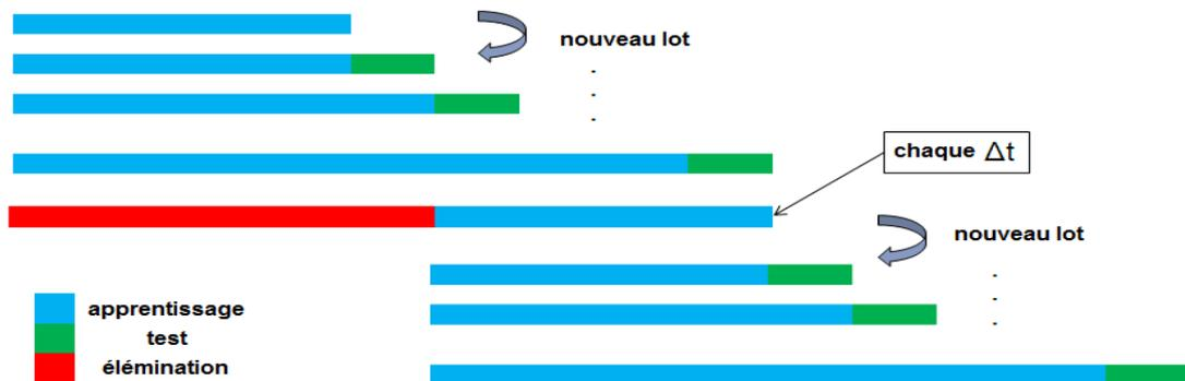
FIGURE 5.2 – Fenêtre mobile du système de détection en temps réel suivant le scénario 1.
