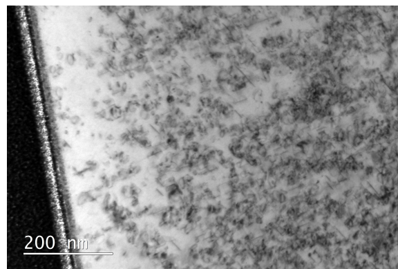
FIGURE 3.25 – Réseau de dislocations proche de la surface irradiée dans le 304L-5 dpa.
